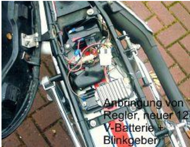
Panasonic-Gel-Batterie 12 V 1.3 Ah passt exakt ins alte Gehäuse
