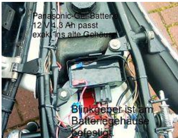
Anbringung von Regler, neuer 12V-Batterie + Blinkgeber
