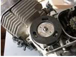
Hochdrehende (bis 18.000U/min) Magnetzündanlage für Sportzwecke. Rotordurchmesser 59mm, Gewicht 210gr.
