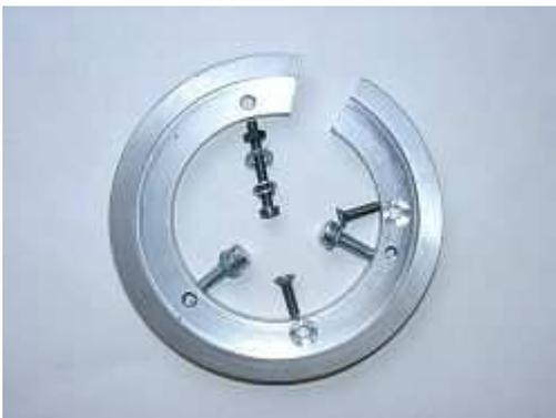
Setzen Sie die Adapterplatte so auf das Kurbelgehäuse dass die Kabelöffnung der Platte auf etwa 2 Uhr, also in Richtung des Kabelausganges zeigt. Verschrauben Sie die Platte mit 2 Senkkopfschrauben M4x15 (die angesenkten Bohrungen).
