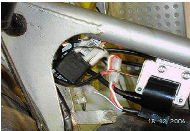
Befestigen sie den elektronischen Wechselstromregler an einer geeigneten Stelle am Rahmen.
