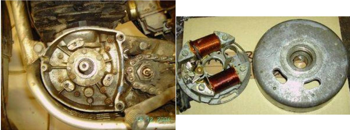
Lösen Sie nun alle Kabel an Ihrer alten Anlage und entfernen Sie diese.
