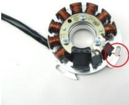
Setzen Sie die vormontierte Statoreinheit auf den Sitz der Lichtmaschine der Bultaco. Verschrauben Sie diese dort mit den 3 Schrauben M5. Führen Sie das Kabel der neuen Lima durch die Kabelöffnung des Motorblocks nach außen.
