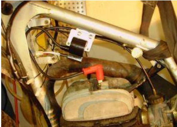
Befestigen sie die neue elektronische Zündspule am Rahmen des Motorrads, z.B. an der selben Lasche, an der schon die originale Zündspule war, wobei Sie ggf. eine Anpassung fertigen müssen da der Lochabstand anders sein kann.
