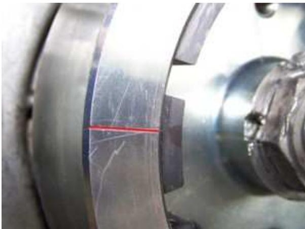
Schauen Sie sich jetzt den Rotor an. Sie werden auf dem Oberkante seiner offenen Seite eine rote Zündmarkierung finden. Diese muß zum Zündzeitpunkt mit der Markierung am Stator übereinander stehen (siehe weiter unten).
