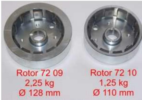
Alle Bilder dieser Einbauanleitung zeigen den schweren Rotor (2.25kg) des Systems 72 09 799 AC!
