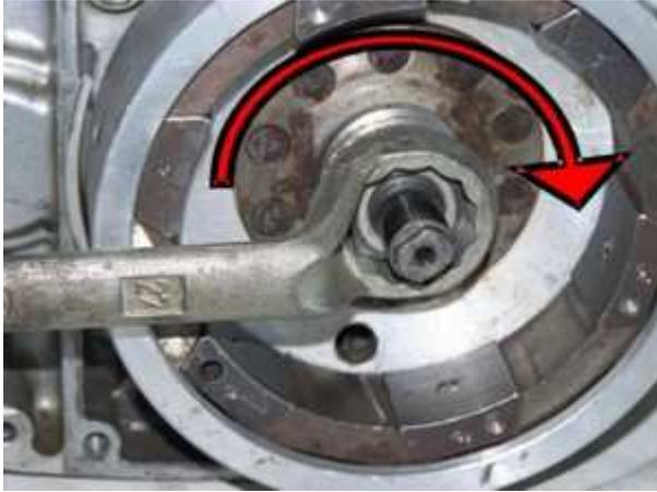
Lösen Sie dazu als erstes die Befestigungsmutter. **Vorsicht, Linksgewinde!** Also im Uhrzeigersinn lösen!
