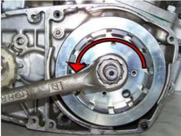
Setzen Sie jetzt den neuen Rotor auf die Kurbelwelle (so wie im Bild gezeigt). Denken Sie daran, daß die Paßfeder auf der Kurbelwelle verbleibt.
