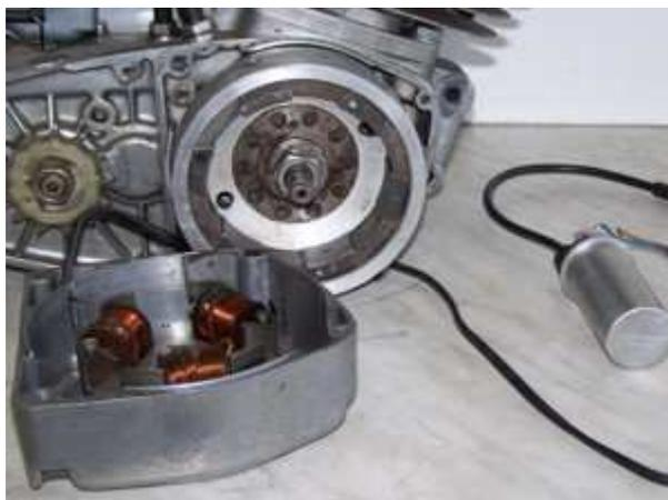
Lösen Sie alle zur alten Lichtmaschine und der Zündspule führenden Kabel und entfernen Sie diese Teile. Sollten sich am Gehäuse irgendwelche Adapter für alternative Lichtmaschinen befinden, bitte auch diese entfernen.
