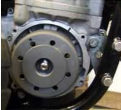
Lichtmagnetzündanlage mit integrierter vollelektronischer Zündung mit automatischer Zündverstellung optimiert für kleine (125ccm) 2 Takter Einzylinder . Lichtleistung
