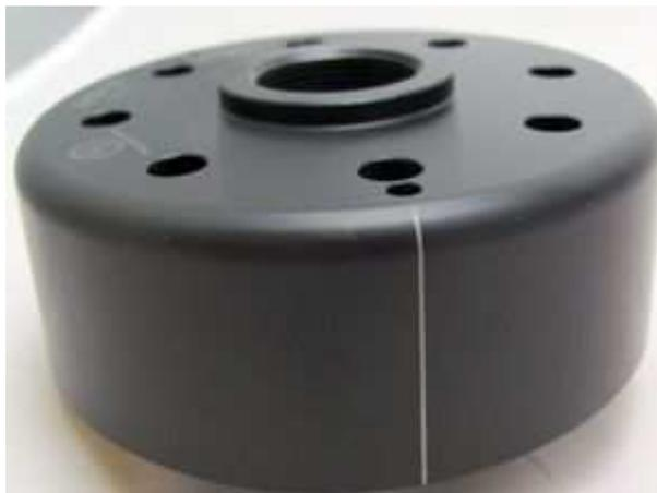
Sehen Sie sich den Rotor an. Auf seinem Umfang befindet sich eine aufgelaserte Linie. Dies ist eine Zündmarkierung. Falls Sie sie nicht gut erkennen können, sollten Sie sie mit einem Filzstift nachziehen.
