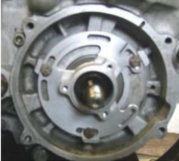
**Achtung:** Merken Sie sich die Stellung, in der der Stator auf der Platte saß. Später muss er genauso wieder aufgeschraubt werden, sonst ist die Zündmarkierung auf der Grundplatte um 120 Grad verdreht!
