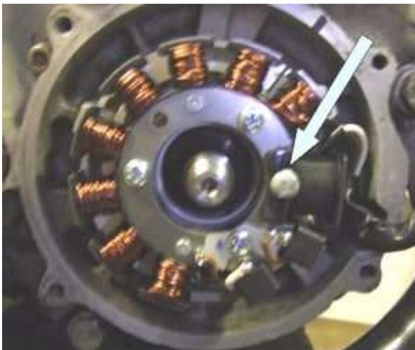
Der Platz zwischen Rotor und Stator ist knapp bemessen. An der Kurbelwelle können eventuell Maßänderungen durch Aufarbeitung entstanden sein. Ebenso kann es sein Sie beuen das System in einen Motor ein für den das System nicht geeignet ist. Daher empfehlen wir dringend den folgenden Test:
