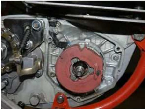
Entfernen Sie den originalen Motoplat (bzw. SEM) Rotor. Dazu benötigen Sie einen Abzieher M26x1.5.
