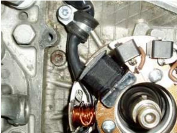
Bei KTM Motoren sichern Sie das Statorkabel z.B. mit einer Kabelschelle damit es nicht am Rotor schleift.
