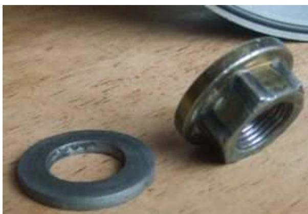
Verschrauben Sie jetzt den Rotor mit der originalen Mutter (für KTM ist das KTM Teilnr. 51030028100, Achtung Linksgewinde!) und Unterlegscheibe.
