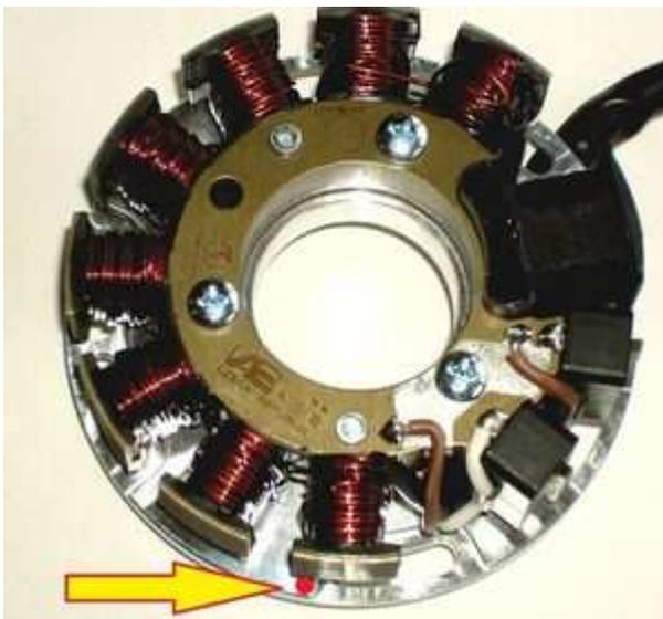
Die Grundplatte hat - etwas rechts von der ersten kupferfarbenen Spule nach den schwarzen Spulen - eine kleine rote Markierung. Dies ist eine Zündmarkierung.
