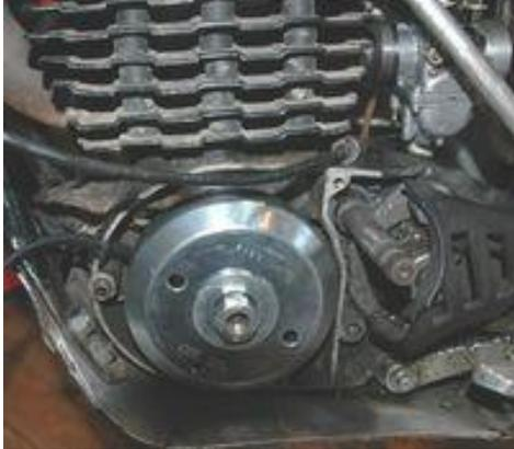
**Lichtmaschine/elektronische Zündung für Bultaco 250/350**
