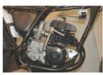
Lichtmagnetzündanlage mit integrierter drehzahlabhängiger vollelektronischer Zündung. Lichtleistung 12V/180W Gleichstrom. Kontaktlose elektronische Zündung mit eigener Stromversorgung innerhalb der Anlage. Ersetzt die alte Lichtmaschine, Fliehkraftversteller, Unterbrecher, Zündspule. (Wenn der Regler nicht benötigt wird auch ohne lieferbar!). Keine Veränderungen am Motorgehäuse notwendig!
