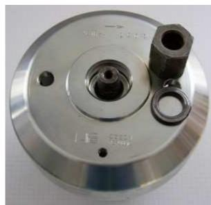
In der Position verschrauben Sie den Rotor sorgfältig mit der originalen Befestigungsmutter.
