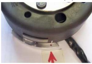
Entfernen Sie die Zündkerze und bringen Sie den Kolben in die Position "Zündzeitpunkt". (Evtl. 2mm vor OT, doch konsultieren Sie dazu die Betriebsanleitung des Motorrades!) Da das ganze per Kickstarter kompliziert ist, nutzen Sie den neuen Rotor zum Drehen der Kurbelwelle.
