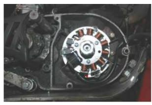
Befestigen Sie den neuen Stator auf ihrem Motor genau so, wie der alte gesessen hat und das Kabel gut aus dem Motor herauszuführen ist.
