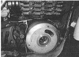
Entfernen Sie den originalen Rotor, verwenden Sie dazu einen passenden Abzieher. Entfernen Sie Lichtmaschine und die Zündspule.
