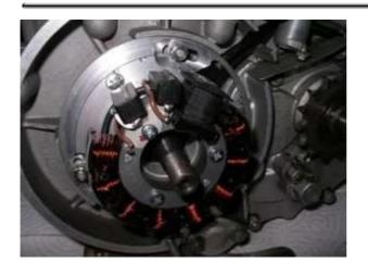
Installez maintenant le nouveau stator a la place de l'ancien en laissant une possibilité de réglage de celui ci d'un cote ou de l'autre (en mettant les vis au milieu des lumières
