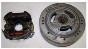
Retirer le volant et les bobinages . Enlevez la clavette sur le cône du vilebrequin avec une pince. Elle n'est plus nécessaire! N'oubliez pas de le faire, autrement vous ne pourriez pas adapter le nouveau rotor correctement. Pas de crainte, la clavette n'a pas pour but de tenir le rotor sur le vilebrequin. Elle ne sert uniquement qu'a simplifie le montage et n'est plus nécessaire dans le nouveau système
