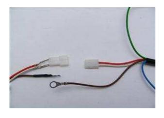
Pour faciliter le passage du câble par des ouvertures étroites la prise de courant du câble conduisant à la nouvelle(s) (aux) bobine(s) d'allumage du nouveau générateur n'est pas monte sur les cosses à l'extrémité du câble. Maintenant vous pouvez les monter. Les cosses entrent dans la prise. vérifiez la position correcte des câbles (couleur) dans la prise!
