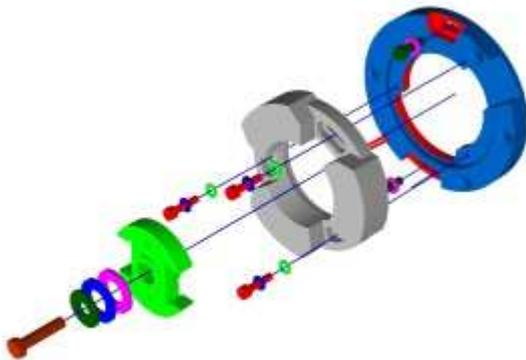
Setzen Sie die neue Adapterplatte inkl. Stator so auf das Kurbelgehäuse, dass die Kabelöffnung der Platte auf etwa 2 Uhr, also in Richtung des Kabelausganges zeigt.
