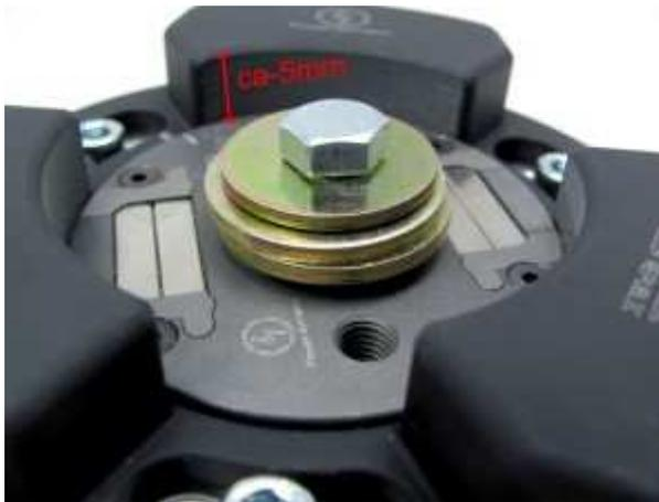
Setzen Sie den Rotor auf die Welle, befestigen ihn aber zunächst noch nicht, er muss eingestellt werden. Es ist richtig das die Oberkante des Rotors ca 5mm unter der Oberkante des Stators liegt.
