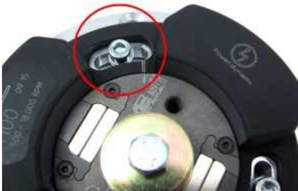
Nutzen Sie die Mitte der Langlöcher zum Verschrauben des Stators um später Spielraum zur Verstellung zu haben.
