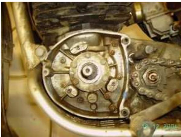
Setzen Sie die vormontierte Statoreinheit auf den Sitz der Lichtmaschine der Bultaco. Verschrauben Sie diese dort mit den 3 Schrauben M5.
