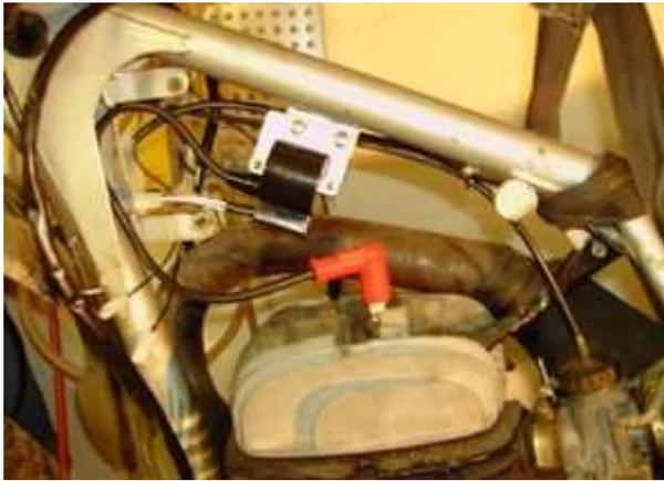
Befestigen sie die neue elektronische Zündspule am rahmen des Motorrades, an der selben Lasche, an der schon die originale Zündspule war.
