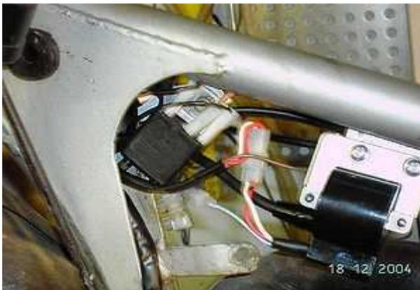
Befestigen sie den elektronischen Regler an einer der Halterungen im Rahmenvorderteil.
