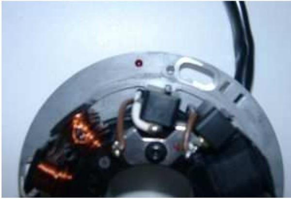
Sehen Sie sich den neuen Stator an. Sie werden etwas links von den 2 kleinen schwarzen Spulen eine kleine rote Markierung finden. Das ist eine Zündmarkierung.
