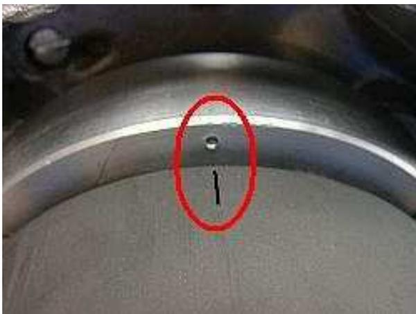
Sehen Sie sich den neuen Rotor an. Sie werden auf seinem Außenumfang eine kleine eingepresste strichförmige Markierung finden. Auch das ist eine Zündmarkierung.
