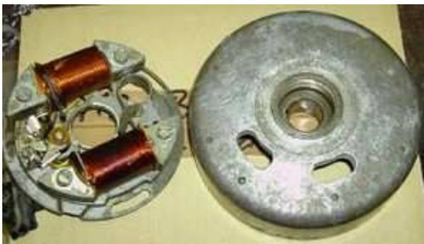
Lösen Sie nun alle Kabel an Ihrer alten Lima und entfernen Sie diese. Nehmen Sie die Passfeder auf dem Konus der Kurbelwelle mit einer Zange ab. Sie wird nicht mehr benötigt! Bitte nicht vergessen sonst müssen Sie die Lima später noch einmal herausnehmen. Keine Angst, die entfernte Passfeder hatte nicht die Aufgabe den Rotor zu sichern, sondern nur zu verhindern, dass er falsch angesteckt wird.
