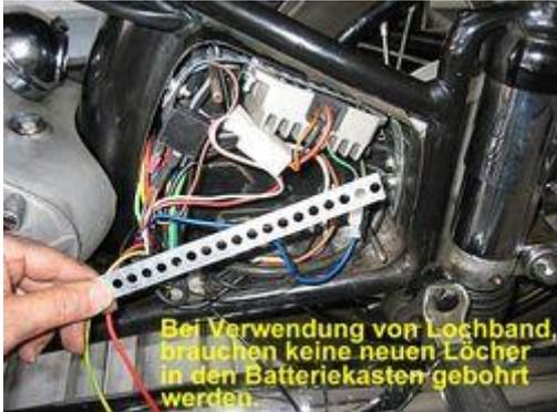
Befestigen sie den elektronischen Gleichrichter/Regler und das Relais an einer geeigneten Stelle, z.B. im Seitenfach.
