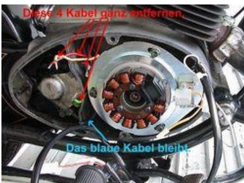
Setzen Sie die vormontierte Statorplatte in das Motorgehäuse und verschrauben Sie diese dort mit den 3 Innensechskantschrauben M6. Die dicke schwarze Spule zeigt dabei ungefähr auf 1 Uhr. Stellen Sie sicher, dass keine Kabel darunter eingeklemmt werden. Sie sollten die Schrauben dabei in der Mitte der Langlöcher setzen um nach beiden Seiten Verstellmöglichkeit zu haben.
