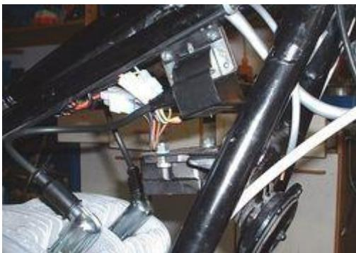
Befestigen Sie die neue elektronische Doppelzündspule an einer geeigneten Stelle, z.B. am Rahmen unter dem Tank. Eine Befestigungsschelle dafür ist mitgeliefert.
