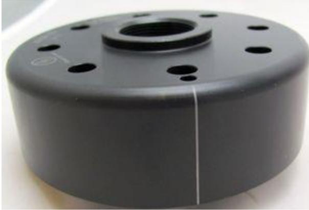
Sehen Sie sich den neuen Rotor an. Sie werden auf seinem Außenumfang eine aufgelaserte Linie finden. Das ist eine Zündmarkierung.
