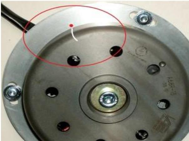
Sehen Sie sich die Grundplatte an. Auch diese hat eine Markierung. Im Zündzeitpunkt stehen die Markierungen auf der Grundplatte und dem Rotor in einer Linie wie hier im Bild gezeigt.
