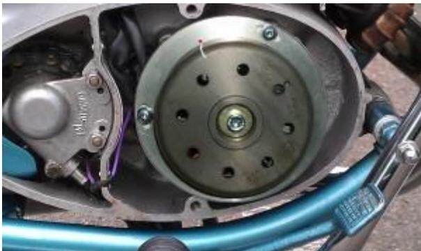
Jetzt können Sie den Rotor mit der Rotorschraube fest anziehen. Zum erneuten Lösen des Rotors verwenden Sie einen Abzieher M27x1,25.
