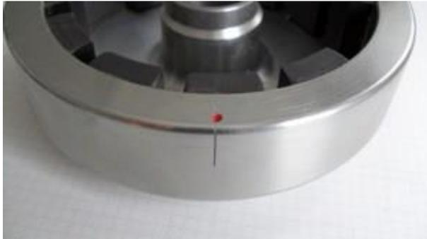
Sehen Sie sich den Rotor an. Er hat eine eingestanzte Linie, die mit einem roten Punkt markiert ist. Dies ist eine Zündmarkierung.
