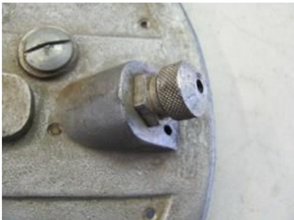
Entfernen Sie ebenfalls die Verschraubung des alten Kabelausgangs. Damit wird Platz für das Kabel des neuen Stators geschaffen.
