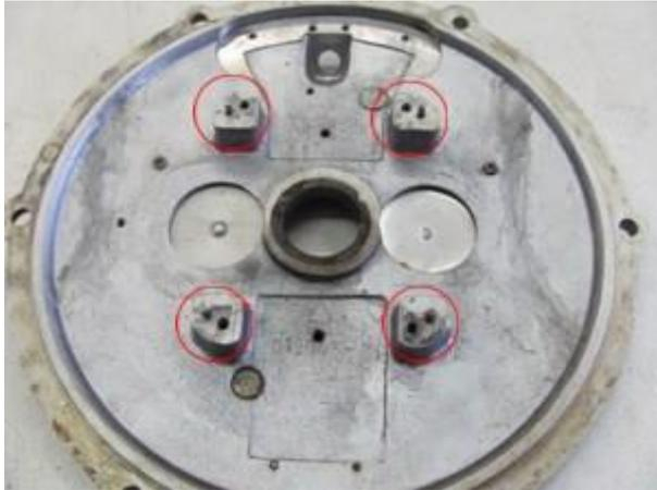
Das Motorgehäuse sollte nun so aussehen. Achten Sie besonders darauf, dass die vier Stifte neben den Gewindebohrungen vorhanden sind (im Bild rot eingekreist). An diesen wird sich die Grundplatte des neuen Stators zentrieren.
