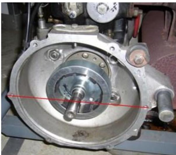
Setzen Sie nun den Rotor so auf den Wellenkonus, dass seine Markierung auf der gedachten Achse zwischen den beiden Bohrungen im Motorgehäuse liegt.
