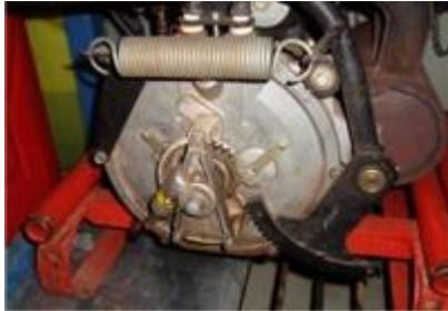
kontaktlose, elektronische Zündanlage für den Stationärmotor ZW1103, verwendet zum Betrieb der DDR Standard Feuerlöschpumpe TS8.
