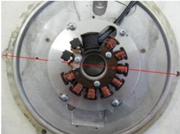
Setzen Sie nun den neuen Stator auf das Motorgehäuse. Dabei sollte die Markierungen auf der Grundplatte (eingravierte Striche) mit den Bohrungen im Motorgehäuse wie im Bild eine Achse ergeben.
