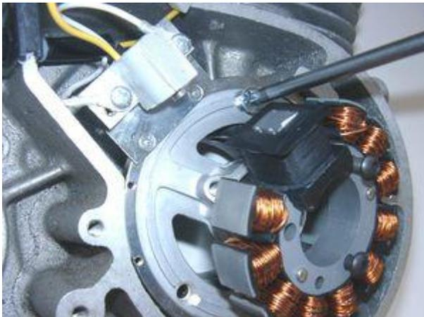
Setzen sie nun die aus zwei Teilen (ein Stahlring und eine Aluminiumplatte) bestehende Statorplatte anstelle der früheren Lichtmaschine auf das Kurbelgehäuse.
