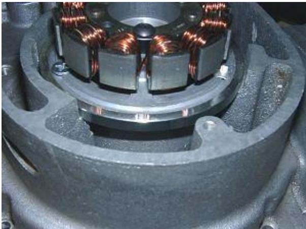
Bitte nehmen Sie auf keinen Fall mechanische Veränderungen am Motorgehäuse vor. Lassen Sie auch keinesfalls den Stahlring weg, auch wenn Sie kurzzeitig (und garantiert fälschlich) der Meinung sein sollten Sie müssten dies tun, um die Grundplatte aufzusetzen. Sie sitzen dabei dem Irrtum auf, die Platte ganz auf den Boden setzen zu müssen. Sie muss aber, wie die alte Lima auch, in der weiter oben gelegenen Halterung sitzen.
