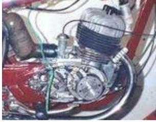
Lichtmagnetzündanlage mit integrierter vollelektronischer Zündung. Lichtleistung 12V/150W Gleichstrom. Kontaktlose, wartungsfreie, elektronische Zündung mit eigener Stromversorgung innerhalb der Anlage, kann daher auch [ohne Batterie](#) betrieben werden. Ersetzt alte Lichtmaschine, Unterbrecher, Zündspule, Regler. Sie benötigen an Ihrem Motorgehäuse keine Veränderungen.
