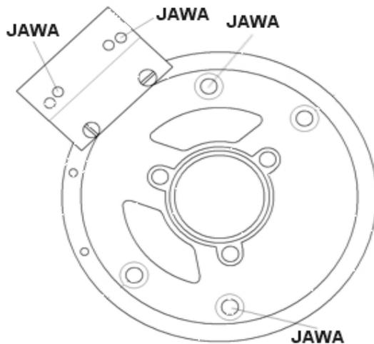
Schrauben Sie den Spulenkörper von der Grundplatte und ziehen Sie ihn etwas von der Platte weg, so dass die Befestigungslöcher zugänglich werden.
