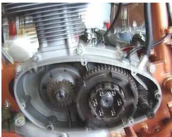
Setzen Sie die Kupplung nun auf die Welle. Prüfen Sie das alles frei laufen kann.
