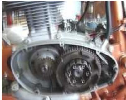
Lichtmagnetzündanlage mit integrierter, vollelektronischer Zündung. Lichtleistung 12V/100W Gleichstrom. Kontaktlose, wartungsfreie elektronische Zündung mit eigener Stromversorgung innerhalb der Anlage. Ersetzt die komplette alte Lichtmaschine. Sie benötigen an Ihrem Motorgehäuse keine Veränderungen.
