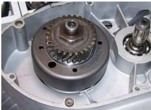
Setzen Sie nun die entfernte Paßfeder wieder in die Nut der Kurbelwelle ein. Jetzt können Sie den Primärtrieb wieder auf die Kurbelwelle setzen und das ganze mit der originalen Rotormutter verschrauben.
