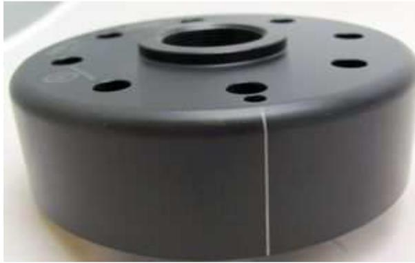
Sehen Sie sich jetzt den Rotor an, auf seinem Außenumfang finden Sie eine kleine aufgelaserte Linie (ältere Versionen eingepresste). Es ist eventuell eine gute Idee diese Linie mit einem Faserschreiber deutlicher zu machen, um sie dann am Motor besser sehen zu können. Auch das ist eine Zündmarkierung.
