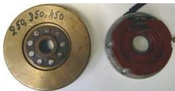
Entfernen Sie die alte Lichtmaschine. Dazu werden Sie einen Ducati Rotorabzieher benötigen.
