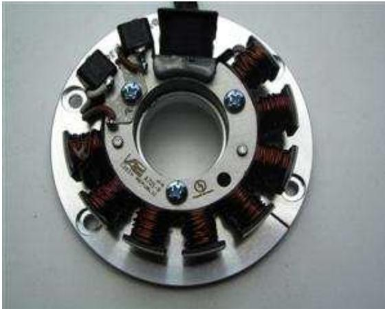
Setzen Sie die neue Statoreinheit auf den Motorblock und verschrauben Sie diese dort mit den gelieferten 4 Schrauben M5.
