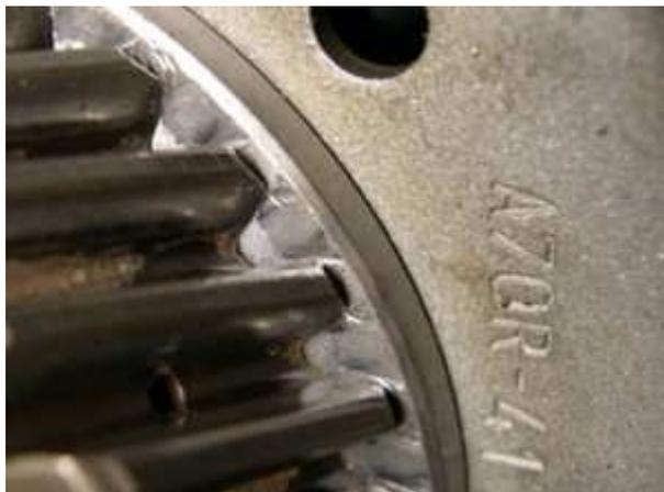
Um einen perfekten Sitz zu gewährleisten haben wir noch Ausgleichscheiben (0,5/1,0mm) beigelegt. Diese Scheiben sind nur bei Bedarf zu verwenden. Prüfen Sie dazu aufmerksam, ob das große Kupplungszahnrad am oberen Absatz des Rotors schleift. In diesem Fall wahlweise eine (oder beide) Ausgleichscheibe(n) unter das große Kupplungszahnrad legen.
