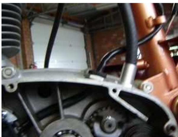
Führen Sie das neue Statorkabel vorsichtig von innen nach außen durch die Kabeldurchgänge.
