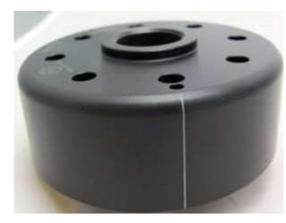
Sehen Sie sich jetzt den Rotor an, auf seinem Außenumfang finden Sie eine kleine Markierung (gekerbte Linie). Es ist eventuell eine gute Idee diese Linie mit einem Faserschreiber deutlicher zu machen, um sie dann am Motor besser sehen zu können. Auch das ist eine Zündmarkierung.
