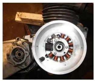
Positionieren Sie die Statoreinheit auf dem Motor und befestigen Sie sie mit den 3 originalen Klemmen.
