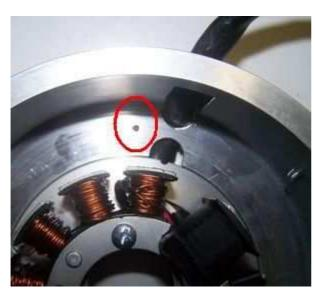
Im Innern der Statoreinheit werden Sie etwas links vom Kabelausgang eine kleine rote Zündmarkierung sehen.
