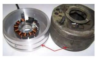
Schauen Sie sich die neue Statoreinheit an. Im unteren Bereich befindet sich auf dem gesamten Außenumfang eine Kerbe zur Befestigung mit den originalen Halteklemmen. Durch diese umlaufende Kerbe ist auch eine genauere Zündeinstellung ohne nochmaliges Abnehmen des Rotors möglich.
