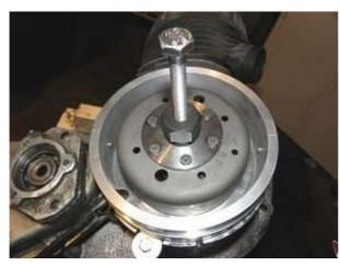
In dieser Position verschrauben Sie den Rotor auf der Kurbelwelle mit der mitgelieferten Schraube M8x1x30 (und der Unterlegscheibe).
