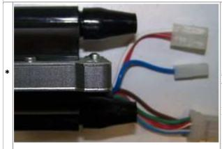
Die Zündenergie wird zusätzlich durch Einspeisung einer aus der Batteriespannung gewonnenen Wechselspannung von 340 Volt verstärkt.
