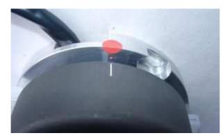
Zur Zündeinstellung drehen Sie bitte die Zündkerzen heraus. Bringen Sie einen der Kolben (egal welchen) in Zündposition (laut Velorex-Anleitung: 3,5mm vor OT). Da sich das mit dem manuellen Starthebel recht schwierig gestaltet, können Sie den aufgesetzten (nicht verschraubten) Rotor als Kurbel zum Drehen der Kurbelwelle benutzen.
