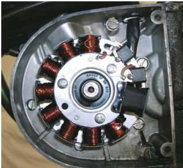
Setzen Sie den Stator wieder auf die nun am Motor verschraubte Grundplatte. Die dicke schwarze Spule zeigt dabei etwa in Richtung Kabelausgang.
