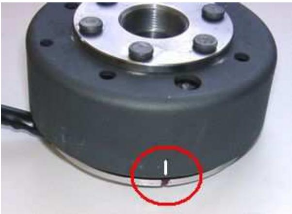
Entfernen Sie die Zündkerze und bringen Sie den Kolben in Zündposition. Das könnten z.B. 2mm vor OT sein. Stecken Sie dazu relativ lose den neuen Rotor auf. Sie können damit die Kurbelwelle drehen.
