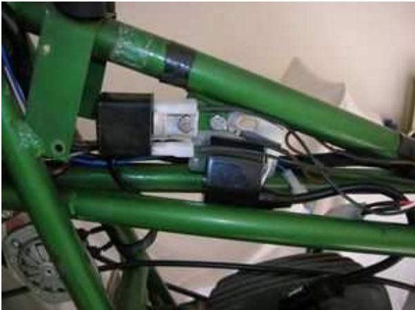
Befestigen sie die neue elektronische Zündspule und den Regler am Rahmen des Motorrades, vorzugsweise dort, wo schon die originale Zündspule war.
