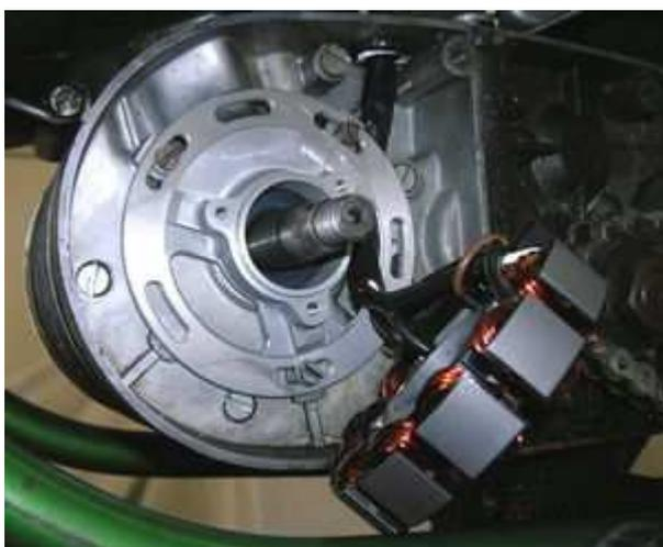
Entfernen Sie die 3 Schrauben, die den neuen Stator auf seiner Grundplatte halten und ziehen Sie ihn etwas von der Platte weg, so daß Sie Zugang zu den Befestigungslöchern darunter erhalten. Achten Sie darauf, die Lackisolierung der Spulendrähte nicht zu beschädigen.
