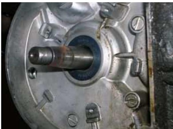
Nehmen Sie bitte die Paßfeder mit einer Zange von der Kurbelwelle. Sie wird nicht mehr benötigt! Bitte nicht vergessen sonst müssen Sie die Lima später noch einmal herausnehmen. Keine Angst, die entfernte Passfeder hatte nicht die Aufgabe den Rotor zu sichern, sondern nur zu verhindern, dass er falsch angesteckt wird.
