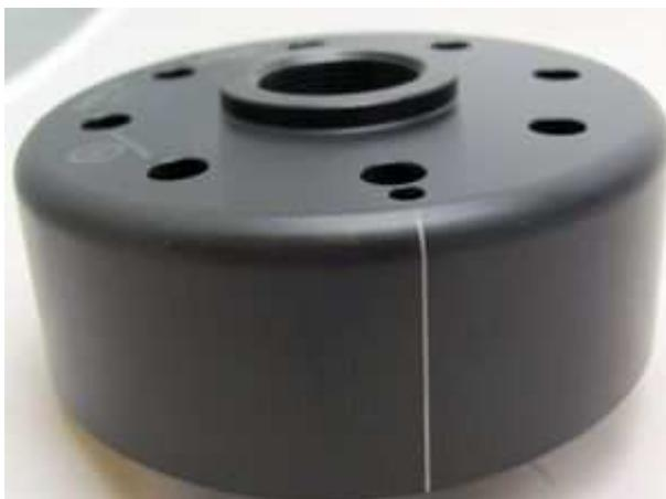
Sehen Sie sich den neuen Rotor an. Auf seinem Umfang finden Sie eine kleine eingepresste Strichmarkierung. Das ist eine Zündeneinstellmarke. Diese ist durch die Einpressung dauerhaft aber eingebaut nicht immer gut zu sehen. Ein Nachziehen mit Faserstift ist daher eine gute Idee.
