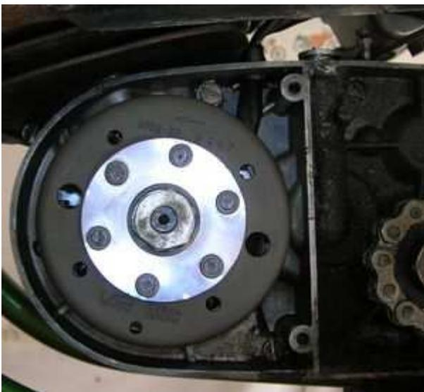
Legen Sie die originale Unterlegscheibe unter und verschrauben Sie den Rotor mit der originalen Mutter.
