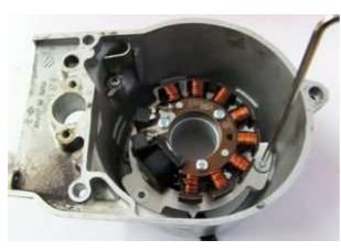
Legen Sie die neue Stator-Einheit in die Motorabdeckung wie hier gezeigt. Befestigen Sie diese mit den 3 Senkschrauben M6.
