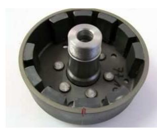
Werfen Sie einen Blick auf die neue Rotor. Sie werden auf ihrem Umfang eine kleine gelasert Linie finden, die an der Oberseite der Seitenwand in rot fortgesetzt wird. Das ist eine Zündungmarkierung.
