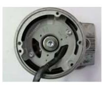
Lichtmaschine / elektronische Zündung <u>für Suzuki T125</u> (Achtung: nicht für GT125)
