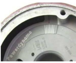
Zur Feineinstellung, lösen Sie <u>ein wenig</u> die kleinen Schrauben an der Platte. Richten sie mit Hilfe der 2. Markierung die Platte aus. Es wird etwas schwerer gehen, da die Magnete gegenhalten.
