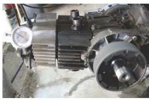
Befestigen Sie den Rotor mit der Schraube M8 und der dazugehörigen Unterlegscheibe. Zum lösen des Rotor bitte nur den mitgelieferten Abzieher benutzen.
