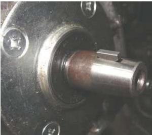
Entfernen Sie die Paßfeder aus der Kurbelwelle, die in die Nut des alten Limarotors ging. Keine Angst, sie hat keine Haltefunktion, sondern sollte nur zur Zündeinstellung führen. Vergessen Sie die Paßfeder zu entfernen, geht später der Rotor nicht auf die Welle und Sie müssen den Stator erneut abbauen um an den Stift zu kommen.
