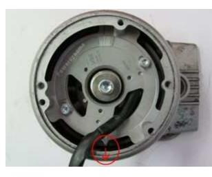
Da die Schrauben 120 Grad von einander entfernt sind ist es möglich, 3 verschieden Einstellungen zu bekommen. Stellen Sie sicher, dass Sie die richtige Position haben. Die richtige Position ist, wenn die Anzeige-Spitze an der Grundplatte (eingekreist im Bild) senkrecht zum Boden zeigt.
