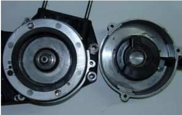
Lösen Sie alle zur alten Lichtmaschine und der Zündspule führenden Kabel und entfernen Sie diese Teile.
