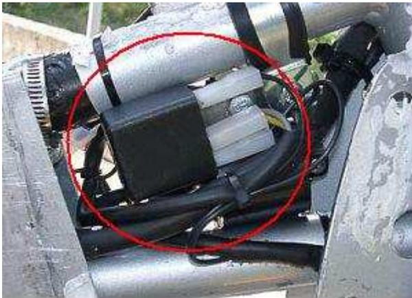
Hier sehen Sie den Vorschlag eines Kunden für die Befestigung der Zündspule und der Steuereinheit:
