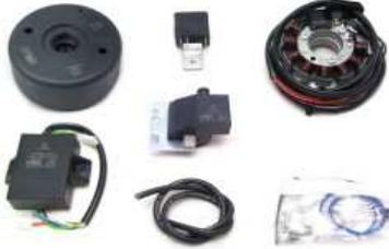
Lichtmagnetzündanlage mit integrierter vollelektronischer Zündung mit automatischer Zündverstellung, Lichtleistung 12V/70W Wechselstrom. Ersetzt die [alte SEM Anlage vom Typ K10](#) einschließlich Zündspule. Sie benötigen an Ihrem Motorgehäuse keine Veränderungen.
