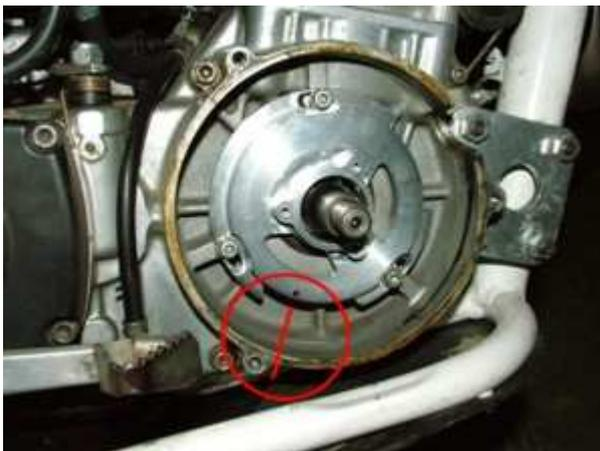
Jetzt übertragen Sie bitte die Zündmarkierung des Stators auf das Motorgehäuse. Gehen Sie dabei sorgfältig vor. Die (gedachte) gerade Linie vom Mittelpunkt der Kurbelwelle muss über die vorhandene Zündmarkierung hinaus verlängert werden.
