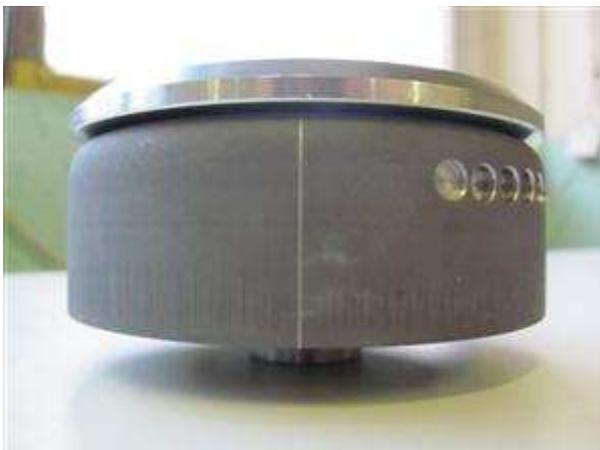
Sehen Sie sich den neuen Rotor an. Auf seinem Umfang finden Sie eine kleine eingepresste Strichmarkierung. Das ist ebenfalls eine Zündeneinstellmarke. Diese ist durch die Einpressung dauerhaft aber eingebaut nicht immer gut zu sehen. Ein Nachziehen mit Faserstift ist daher eine gute Idee.
