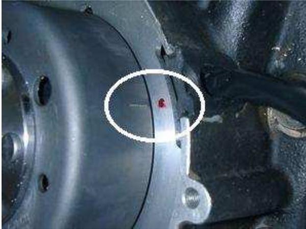
Entfernen Sie die Zündkerze und bringen Sie den Kolben in den oberen Totpunkt. Das ist der höchste Punkt den der Kolben erreichen kann und er ist einfacher zu finden als ein Zündpunkt. Die Verstellung dorthin übernimmt die automatische Zündeneinstellung. Zum Drehen der Welle können Sie den Rotor leicht aufsetzen und als Knopf benutzen.
