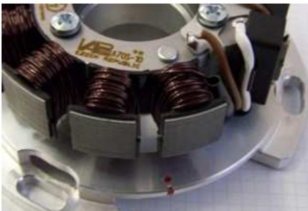
Schauen Sie sich die neue Statoreinheit an. Sie werden dort (etwas neben den kleineren schwarzen Spulen) eine rote Markierung finden. Diese Zündmarkierung ist nach Aufsetzen des Rotors nicht mehr sichtbar und muss deshalb auf das Motorgehäuse übertragen werden.
