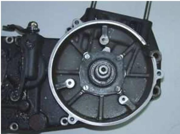
So sieht der Motor ohne die alte Anlage aus, wenn nicht früher mal, durch Einbau einer völlig anderen Anlage am Motor gefräst wurde.
