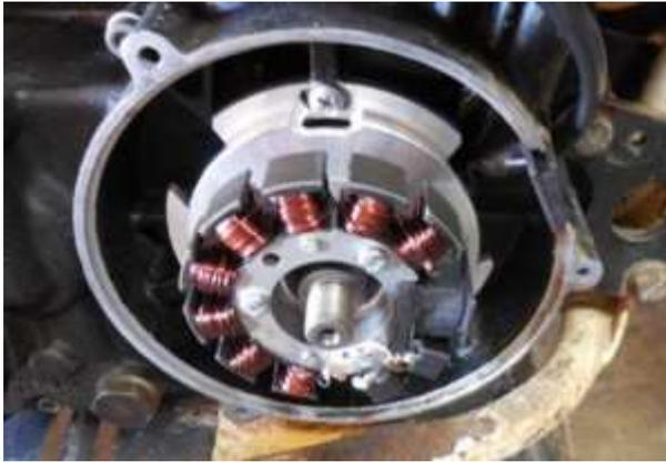
Setzen Sie die neue Statoreinheit auf den Motor. Sie muss in den 3 Aufnahmen am Motorblock zentrieren und wird dort auch mit den 3 Schrauben M5 verschraubt. Das Kabel zeigt natürlich in Richtung Kabelausgang des Motorblocks.
