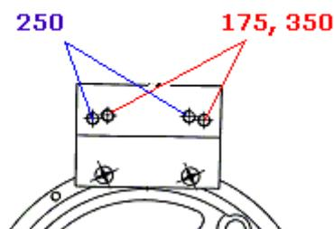
Prüfen Sie zunächst die Aufschraubposition des Sensors auf der seitlichen eckigen Platte. Hier gibt es 2 Befestigungsmöglichkeiten.
