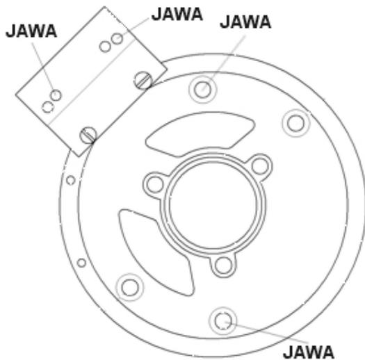
Schrauben Sie den Spulenkörper von der Grundplatte und ziehen Sie ihn etwas von der Platte weg, so dass die Befestigungslöcher zugänglich werden.
