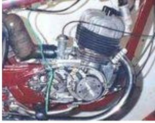
Lichtmagnetzündanlage mit integrierter vollelektronischer Zündung. Lichtleistung 6V/100W Gleichstrom. Kontaktlose, wartungsfreie, elektronische Zündung mit eigener Stromversorgung innerhalb der Anlage, kann daher auch [ohne Batterie](#) werden. Ersetzt alte Lichtmaschine, Unterbrecher, Zündspule, Regler. Sie benötigen an Ihrem Motorgehäuse keine Veränderungen.
