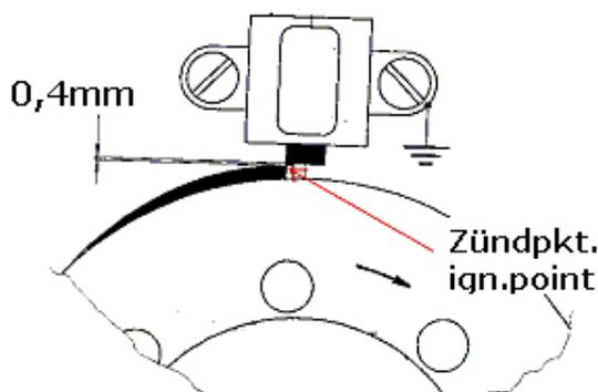
Drehen sie den Rotor von Hand durch (zur Leichtgängigkeit Kerze entfernen). Prüfen sie den Abstand zwischen dem Sensor und einer der zwei Steuernasen des Rotors. Dieser muss ca. 0,4mm betragen. Sie können den Abstand nach Lösen der beiden Halteschrauben des Sensors durch Verschieben regulieren.
