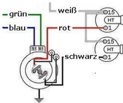
Lösen Sie nun alle Kabel an Ihrer alten Lichtmaschine, dem Regler und der Zündspule und entfernen Sie diese Teile. Den alten Rotor bekommen Sie mit Hilfe einer Abziehschraube M8x90 ab.
