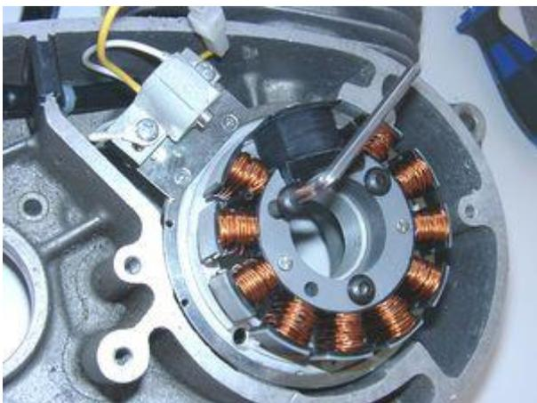
Setzen Sie den Spulenkörper wieder auf die Platte, so dass die Kabel sauber durch die Plattenöffnung gehen können und nicht eingeklemmt werden.
