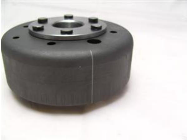
Sehen Sie sich jetzt den Rotor an, auf seinem Außenumfang finden Sie eine kleine Markierung (gekerbte Linie).
