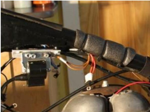
Die neue Zündspule wird unter dem Tank befestigt. Manche Fahrwerke haben dort bereits eine Aufnahme mit passenden Löchern. Wenn dies nicht der Fall ist, kann man sich mit [einem selbstgebauten kleinen Blech](#) oder Kabelbindern behelfen. Es geht hier etwas knapp zu, aber die die Spule passt hinein.
