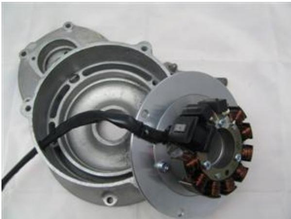
Führen Sie das Statorkabel von innen durch die Kabelbohrung am Motor.
