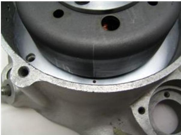
Ist die OT Position gefunden, ziehen Sie den Rotor wieder vorsichtig ab (Dabei nicht die Position der Kurbelwelle ändern!) und setzen ihn so auf, daß die Markierung des Rotors (wie hier im Bild rot eingekreist gezeigt) auf Höhe der roten Markierung der Grundplatte steht.
