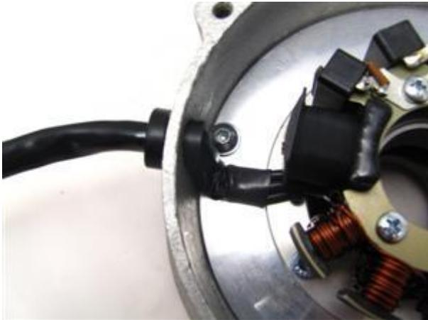
Ziehen Sie die mitgelieferte Kabeltülle über das Kabel und schieben Sie diese bis zum Gehäuse. etwas Öl hilft beim Gleiten über das Kabel.
