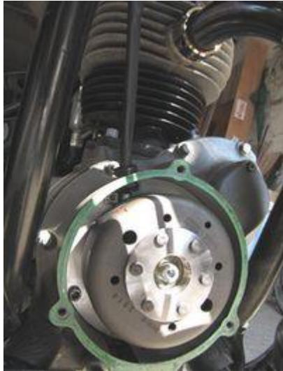
Lichtmagnetzündanlage mit integrierter drehzahlabhängiger vollelektronischer Zündung, Lichtleistung 12V/180W Gleichstrom. Kontaktlose, wartungsfreie, elektronische Zündung mit eigener Stromversorgung innerhalb der Anlage.
