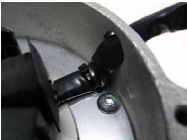
Ist das Kabel ganz durch, drücken Sie die neue Statoreinheit nach unten in den Sitz der Lichtmaschine. Achten Sie darauf, daß die Befestigungslöcher auch über den Bohrungen stehen.
