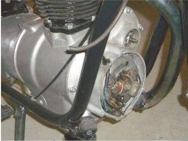
Nehmen Sie den Lichtmaschinendeckel (Schutzkappe) des Motors ab und klemmen Sie die Kabel an der Lichtmaschine ab.
