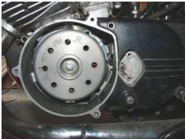
Nehmen Sie den Rotor wieder vorsichtig ab, ohne dabei die Zündposition der Kurbelwelle zu verändern. Anschließend setzen Sie den Rotor wieder so auf, daß die beiden Zündmarkierungen genau übereinander stehen. In dieser Stellung befestigen Sie den Rotor mit der neuen mitgelieferten Schraube.
