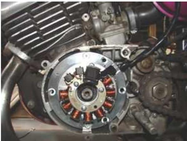
Setzen Sie die Statoreinheit auf den Motor. Kabelabgang in Richtung 2 Uhr, wie bei der originalen Anlage.
