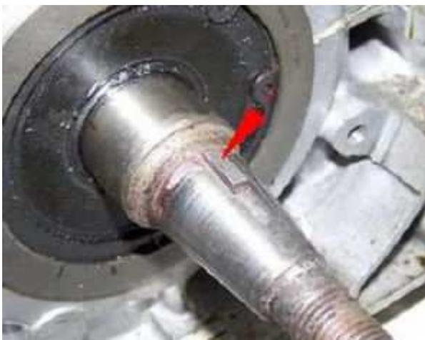
Entfernen Sie den Paßstift auf der Kurbelwelle, der in die Nut des alten Limarotors ist. Keine Angst, der hat keine Haltefunktion, er sollte nur zur Zündeneinstellung führen. Vergessen Sie den Stift zu ziehen, geht später der Rotor nicht auf die Welle und Sie müssen den Stator erneut abbauen um an den Stift zu kommen.
