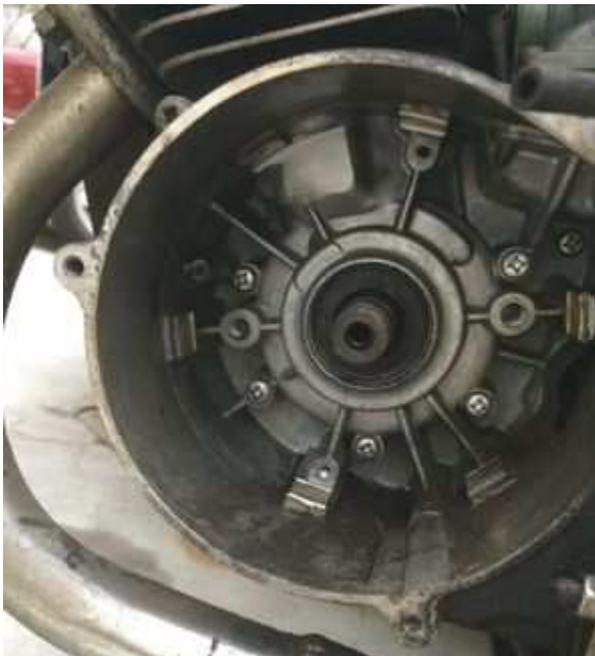
Lösen Sie alle Kabel vom alten Zündanlage und entfernen Sie diese Teile.
