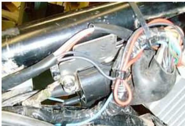
Jetzt müssen Sie noch einen geeigneten Platz am Rahmen für die Befestigung von Zündspule und Regler/Gleichrichter finden.
