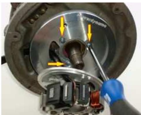
Setzen jetzt Sie die neue Adapterplatte (mit dem lose daran hängendem Stator) auf den Motorblock und verschrauben Sie ihn sorgfältig mit den mitgelieferten 3 Schrauben M4x35. Achten Sie dabei darauf, daß diese Adapterplatte eben auf dem Motorgehäuse aufsitzt.
