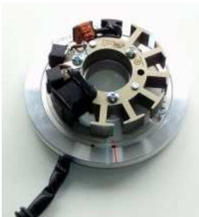
Sehen Sie sich die neue Statoreinheit an. Nahe des Kabelausganges finden Sie eine rote Zündmarkierung.
