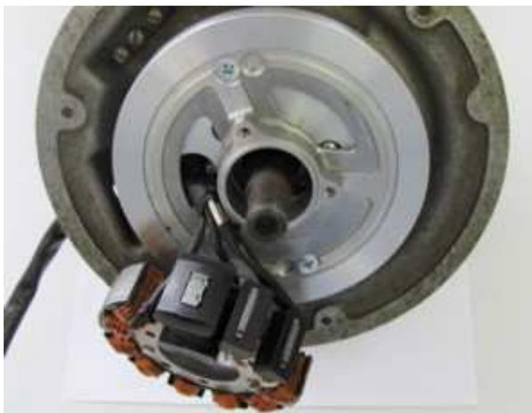
Als nächstes wird die Statorträgerplatte auf der Adapterplatte mit den beiden Senkkopfschrauben M5 verschraubt. Achten Sie darauf die richtigen Löcher der Trägerplatte zu verwenden (siehe Bild).
