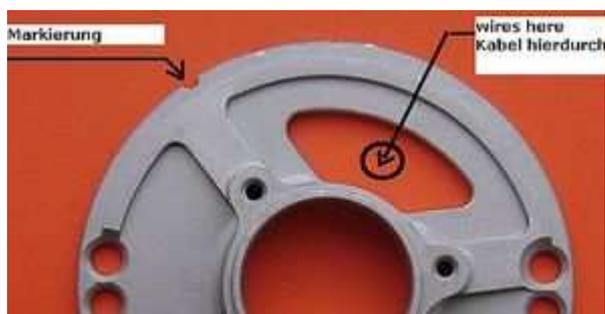
Beachten Sie die kleine rote Markierung an dem Adapter. Das ist eine Zündmarkierung. Sie muss auf Höhe der hier mit <Markierung> gezeigten kleinen Kerbe des Trägers stehen.
