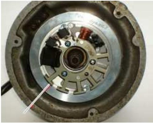
Da die Zündmarkierung der Statoreinheit von dem aufgesetzten Rotor verdeckt wird, müssen Sie diese auf den Motor übertragen.
