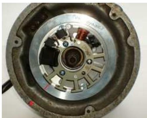
Stellen Sie sicher, daß die innere Öffnung des Stators sauber auf dem erhöhten Befestigungsbund der Trägerplatte sitzt, ansonsten sitzt der Stator schief und würde durch den drehenden Rotor beschädigt. Der Stator muß hörbar einrasten, sitzt er "weich" auf, haben Sie garantiert ein Kabel darunter eingeklemmt. Seien Sie besonders vorsichtig: diese Stelle der Montage ist ganz besonders "tricky"!
