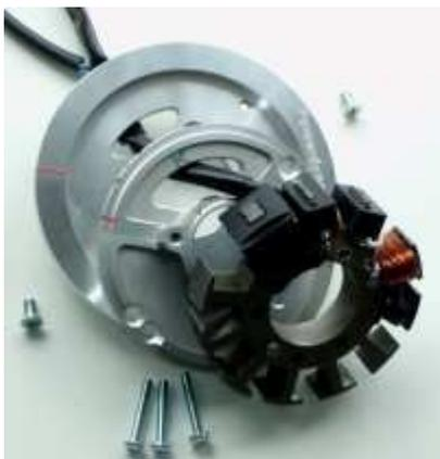
Lösen Sie jetzt als erstes die drei Befestigungsschrauben des Stators und heben ihn vorsichtig von der Trägerplatte. Als nächstes lösen Sie auch die beiden Befestigungsschrauben dieser Trägerplatte. Merken Sie sich, wie die beiden Platten aufeinander geschraubt waren.
