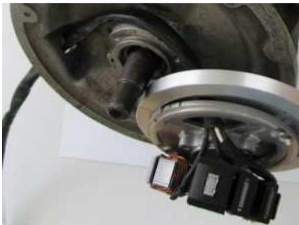
Nehmen Sie jetzt diese auseinander geschraubte Statoreinheit und führen Sie das Statorkabel vorsichtig durch den Kabelausgang des Motorgehäuses.
