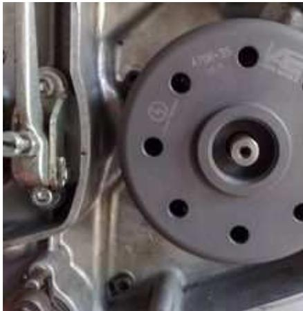
Entfernen Sie die Zündkerze und bringen Sie den Kolben in Zündposition. Sehen Sie dazu in Ihrer Bedienungsanleitung nach. Wenn Sie keine Angabe finden, probieren Sie 2mm vor OT. Stecken Sie dazu relativ lose den neuen Rotor auf. Sie können damit die Kurbelwelle drehen.
