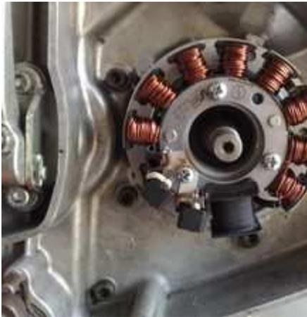
Setzen Sie den Stator wieder auf die nun am Motor verschraubte Grundplatte. Die Spule muss dort recht hart einrasten. Setzt Sie nur weich auf die Platte auf, ist mit großer Sicherheit ein Kabel darunter eingeklemmt! Stellen Sie sicher, daß der Stator gerade auf der Platte sitzt und keine Kabel eingeklemmt sind - ansonsten kommt es zur Zerstörung der Anlage oder zumindest Fehlfunktionen.
