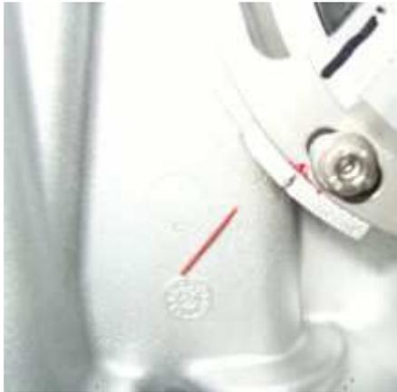
Diese Markierung ist nicht mehr sichtbar wenn der Rotor angebracht ist. Daher muss sie auf das Motorgehäuse übertragen werden.
