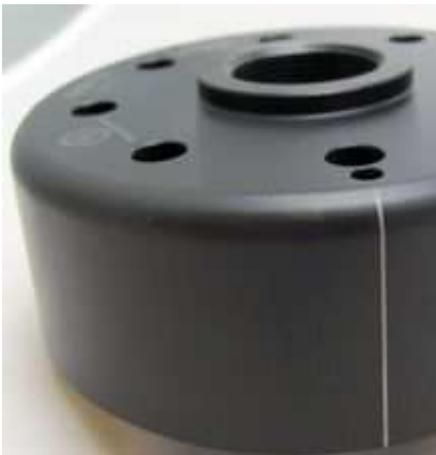
Sehen Sie sich den neuen Rotor an. Auf seinem Umfang finden Sie eine kleine eingepresste Strichmarkierung. Das ist eine Zündeneinstellmarke. Diese ist durch die Einpressung dauerhaft aber eingebaut nicht immer gut zu sehen. Ein Nachziehen mit Faserstift ist daher eine gute Idee.
