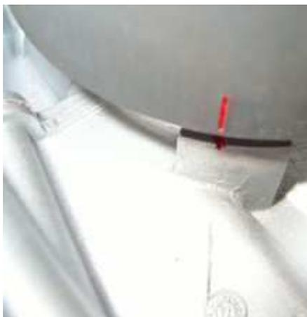
Halten Sie die Stelle des Zündzeitpunktes, nehmen Sie den neuen Rotor vorsichtig wieder ab und stecken Sie ihn so wieder auf, daß die Markierungen des Rotors und der Statorplatte miteinander fluchten. Legen Sie die originale Unterlegscheibe unter und verschrauben Sie den Rotor mit der originalen Mutter.
