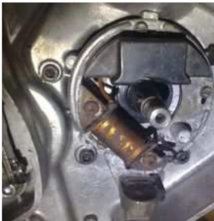
Lösen Sie alle zur alten Licht/Zündanlage führenden Kabel und entfernen Sie diese Teile.
