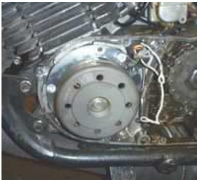
Dies ist kein komplettes Zündsystem. Nur Alternator zur Erzeugung von Lichtstrom mit nominal 12VDC (13.8V) sowie 2 Impulse je Umdrehung von einem [VAPE Sensor S01](#) ausgelöst über [2 gerade Geberzeichen](#).
