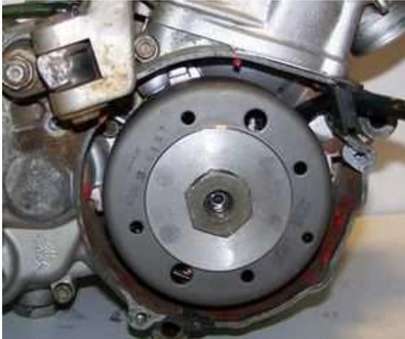
In dieser Position den Rotor vorsichtig mit der originalen Mutter verschrauben.
