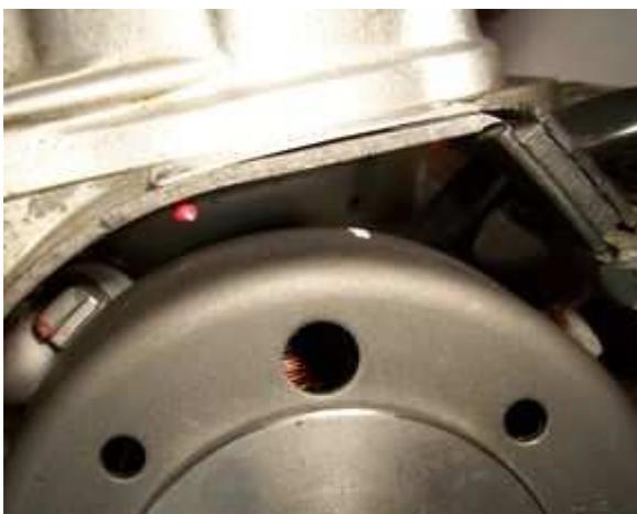
Stecken Sie den Rotor lose auf die Kurbelwelle und überprüfen Sie dabei, daß er sich frei über den Statorspulen und der Grundplatte drehen läßt.
