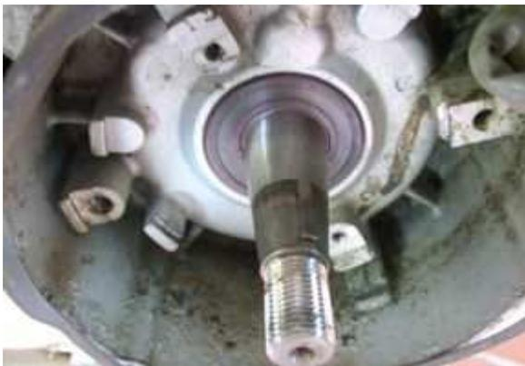
Entfernen Sie den alten Rotor - dazu benötigen Sie einen speziellen Abzieher. Lösen Sie die Schrauben des alten Stators und nehmen Sie ihn vom Motor ab.
