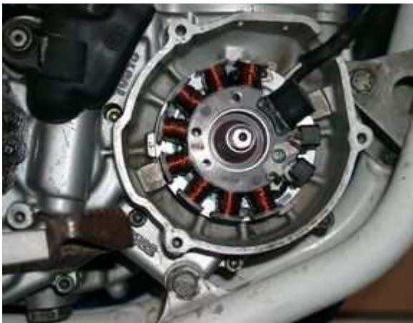
Setzen Sie die Statoreinheit wieder zurück auf die Grundplatte. Gehen Sie dabei vorsichtig vor, um keine Kabel zu beschädigen. Der Stator muß dort recht hart einrasten. Setzt er weich auf, haben Sie garantiert ein Kabel darunter gequetscht.
