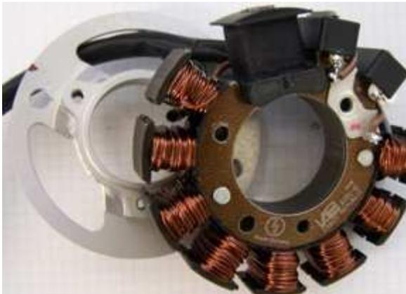
Lösen Sie die 3 Statorbefestigungsschrauben und heben Sie die Statorspulen soweit an, daß Sie die darunter befindlichen Befestigungslöcher erreichen können. Achten Sie darauf nicht die Lackisolierung der Spulendrähte zu beschädigen.
