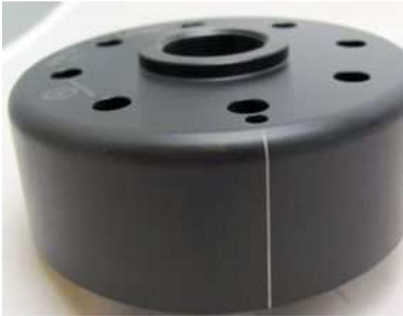
Sehen Sie sich den neuen Rotor an. Auf seinem Umfang finden Sie eine kleine eingepresste Strichmarkierung. Das ist eine Zünderstellmarke. Diese ist durch die Einpressung dauerhaft aber eingebaut nicht immer gut zu sehen. Ein Nachziehen mit Faserstift ist daher eine gute Idee.
