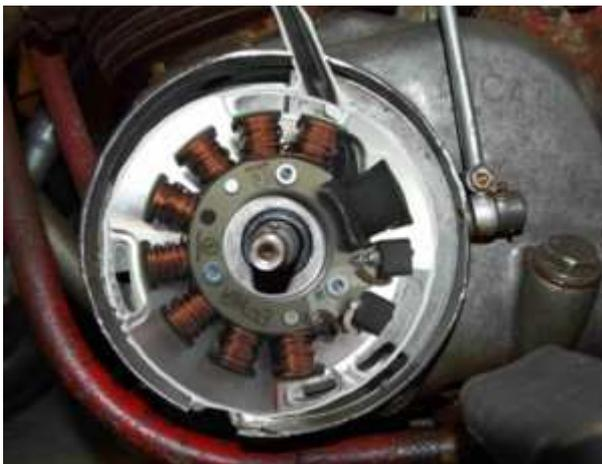
Setzen Sie die vormontierte Statoreinheit auf den Motor und verschrauben Sie sie dort mit den mitgelieferten M5 Schrauben.
