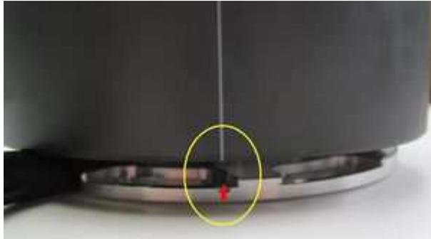
Nehmen Sie jetzt den Rotor wieder vorsichtig ab ohne dabei die Zündposition der Kurbelwelle zu verändern. Stecken Sie den Rotor wieder so auf die Kurbelwelle, dass die beiden oben beschriebenen Zündmarkierungen auf Grundplatte und Rotor genau übereinander stehen.
