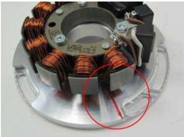
Schauen Sie sich die neue Statoreinheit an. Sie finden auf der Grundplatte eine rote Markierung. Das ist eine Zündmarkierung.
