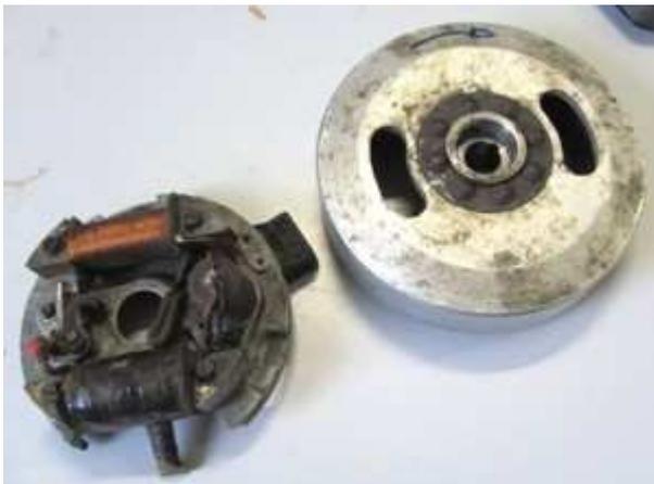
Entfernen Sie die alte Lichtmaschine und alle Kabel, die zu ihr führten.
