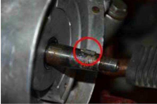
Entfernen Sie die Passfeder auf der Kurbelwelle, die in die Nut des alten Limarotors ging. Keine Angst, sie hatte keine Haltefunktion, sie sollte nur zur einfachen ZündEinstellung führen. Vergessen Sie die Passfeder zu ziehen, geht später der Rotor nicht auf die Welle und Sie müssen den Stator erneut abbauen um an die Passfeder zu kommen.
