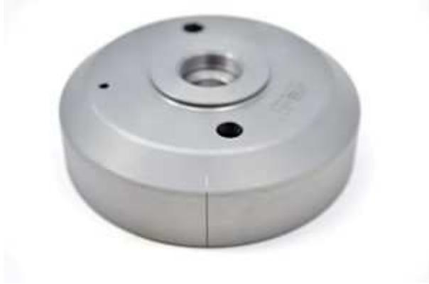
Schauen Sie sich den neuen Rotor an. Auf seinem Außenumfang ist eine gelaserte Linie. Dies ist ebenfalls eine Zündmarkierung.
