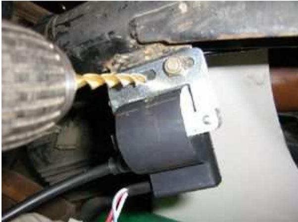
Befestigen Sie die Zündspule, Steuereinheit und Regler an einem geeigneten Ort.
