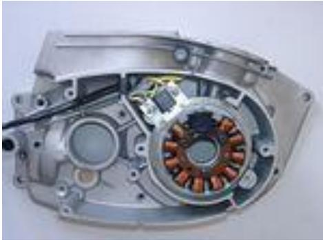
**Vorteile gegenüber Originalsystem****12 Volt Lichtmaschine/elektronische Zündung für Schwedische Armee JAWA (JAWA 255A/257A)**
