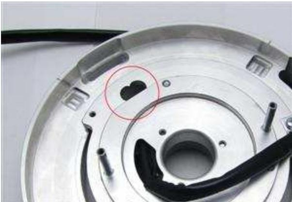
Jetzt wird die vormontierte Statorplatte auf den Motor gesetzt. Dabei muss das Loch zur Zündeneinstellung (siehe Bild) ebenfalls in Richtung des Schraubenloches oben rechts zeigen.
