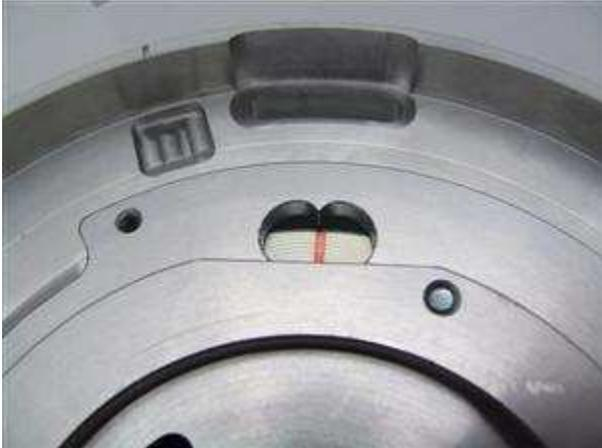
Drehen Sie die Statorplatte in den Langlöchern nun so, dass die rote Kerbe auf dem Rotor genau mit den Spitzen in dem Loch zur ZündEinstellung übereinstimmt.
