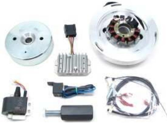
Ersetzt die [originale Zündlichtmaschine Noris SDZ 6/30](#), rüstet auf 12V/180W und kontaktlose elektronische Zündung auf. Der Zündzeitpunkt ist statisch, die modernen Kraftstoffe machen eine Verstellung überflüssig. Das Gewicht des neuen Rotors beträgt 2,7 kg (das ist weniger als das originale Gewicht, hat sich aber als völlig geeignet erwiesen).
