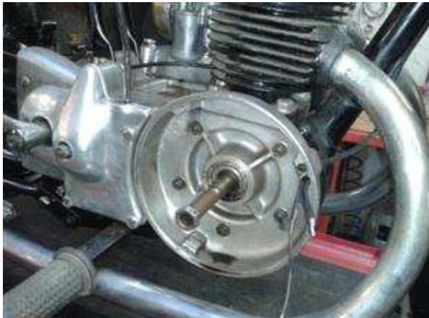
Entfernen Sie den Passstift auf der Kurbelwelle, der in die Nut des alten Limarotors ging. Keine Angst, der hat keine Haltefunktion, er sollte nur zur Zündeneinstellung führen. Vergessen Sie den Stift zu ziehen, geht später der Rotor nicht auf die Welle und Sie müssen den Stator erneut abbauen um an den Stift zu kommen.
