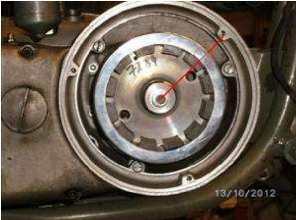
Um die Welle besser drehen zu können setzen Sie den neuen Rotor lose auf und nutzen Sie ihn als Drehgriff (nicht verschrauben). Ist die korrekte Position gefunden, ziehen Sie den Rotor vorsichtig wieder ab.
