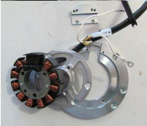
Die Position des Stators ist unwichtig, solange die schwarze Spule nicht unter den Sensor zu sitzen kommt (das muss vermieden werden).
