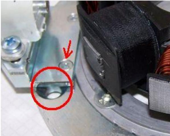
Bitte beachten Sie, daß der Sensorhalter nur lose mit 2 kleinen Senkkopfschrauben M3 auf der Grundplatte des Stators angeschraubt ist.
