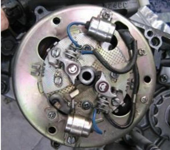
Ziehen Sie alle Kabel von der alten Lichtmaschine, dem Regler und den Zündspulen ab und entfernen Sie diese Teile.
