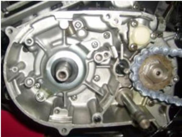
Entfernen Sie die [Paßfeder vom Kurbelwellenzapfen, er wird nicht mehr benötigt](#) und würde der Montage des Systems im Weg stehen. Wenn Sie das jetzt vergessen, müßten Sie später das ganze neue System noch mal zerlegen.
