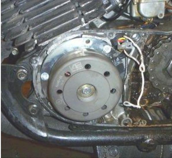
Setzen Sie den Rotor auf die Kurbelwelle ohne ihn zu befestigen.
