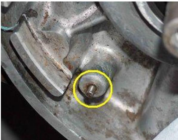
**Überprüfen Sie ob sich am äußeren Umfang des Lichtmaschinensitzes ein kleiner Stift befindet.** Er sollte bei ihrer alten Lichtmaschine verhindern, daß diese falsch aufgesetzt wird. Sie müssen **diesen Stift unbedingt entfernen** (eventuell mit einer Zange herausziehen).
