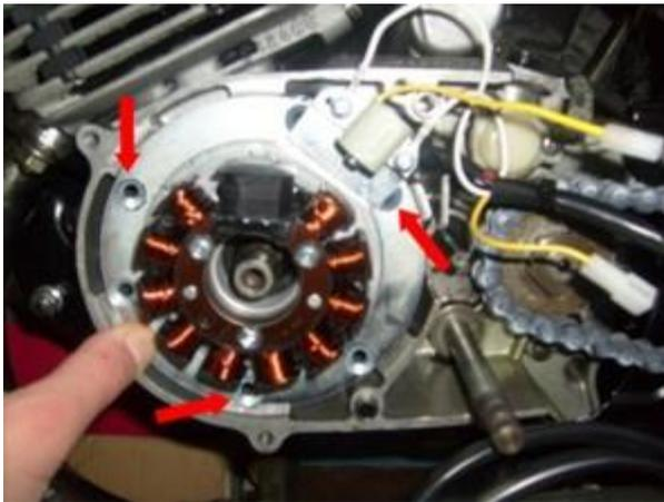
Setzen Sie die Grundplatte auf den Motor und schrauben Sie die beiden unteren Senkkopfschrauben M6x16 lose ein.
