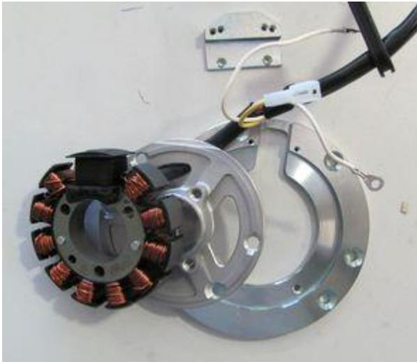
Die Statoreinheit besteht aus 2 aufeinanderliegenden Adapterplatten:
