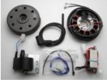
**Vorteile gegenüber dem alten System:****Lichtmaschine/elektronische Zündung für Husquarna CR250, ???(ca.1996-2000) mit original 110 mm Platte / 77.4mm Rotor Kokusan Zündung rechtsdrehend!**
