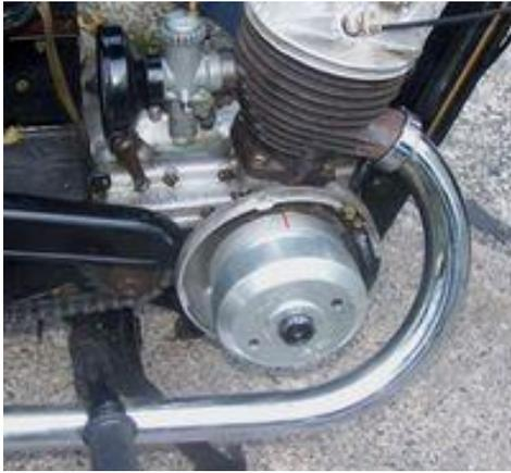
**Vorteile gegenüber dem alten System:****Lichtmaschine/elektronische Zündung für DKW KS/KM200**
