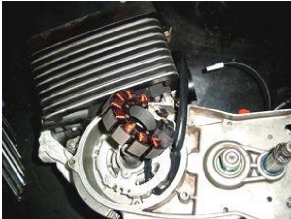
Kabel vede, na rozdíl od zobrazení na obrázku (obrázek znázorňuje starší verzi desky!), směruje ve směru hodinových ručiček nahoru a poté k výstupu motoru.
