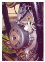
Kontaktlose (ohne Kohlen) 1-Phasen-Lichtmaschine mit einer Ausgangsleistung von 12V/190W Gleichspannung. Ersetzt die originale 3-Phasen Bosch Lichtmaschine sowie den Regler und Gleichrichter. Es sind keine Veränderungen am Motorblock notwendig.
