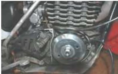
vollelektronische Zündung, **keine Lichtstromerzeugung**. Ersetzt die alte Magnetzündanlage Fliehkraftversteller, Unterbrecher, Zündspule. Keine Veränderungen am Motorgehäuse notwendig!
