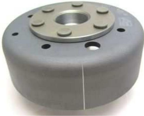
Sehen Sie sich jetzt den Rotor an, auf seinem Außenumfang finden Sie eine aufgelaserte (ältere Rotoren eingepresste) Markierung .
