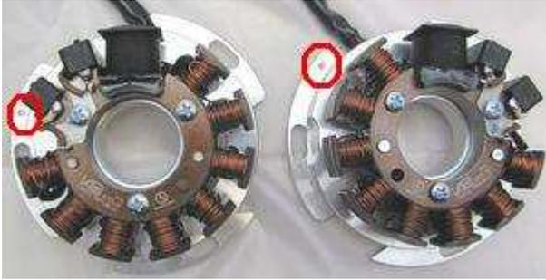
Sehen Sie sich die vormontierte Statorplatte an. Sie werden dort eine rote Markierung finden. Dies ist eine Zündmarkierung.
