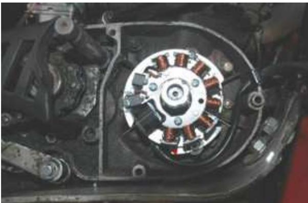
Setzen Sie die Statoreinheit auf den Motor, dort wo die alte Einheit verschraubt war und befestigen Sie diese dort mit den 3 Schrauben M5x16.
