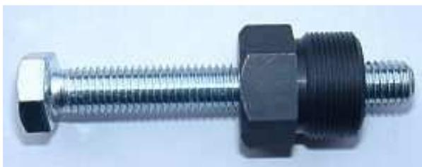
[Zum Abziehen des neuen Rotors](#) verwenden Sie
