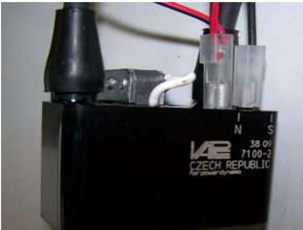
Befestigen Sie die neue [Doppelzündspule](#) am Fahrzeug. Schrauben Sie die beiden Hochspannungskabel dort ein und stecken Sie die beiden Stecker des aus dem Stator kommenden Kabels auf die Kontaktfahnen der Zündspule. Diese Kontakte haben verschiedene Abmessungen um Verpolung zu verhindern. Diese Zündspule ist nicht nur Transformator, sondern enthält eine Kondensatorzündung.
