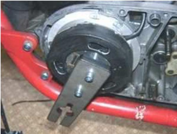
Das gleiche Werkzeug wird mit seiner anderen Seite auch als Abzieher für den Rotor genutzt.
