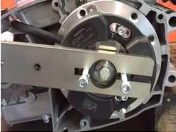
Um den Rotor sowohl bewegen, als auch beim Festziehen stabilisieren zu können, nutzen Sie das beiliegende Werkzeug wie auf dem Bild gezeigt.
