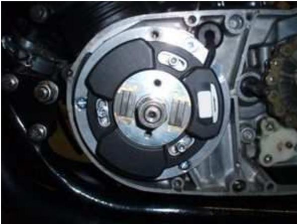
Verschrauben Sie den Rotor mit der originalen Mutter, vergessen Sie nicht die beiden Distanzbuchsen darunter zu geben.
