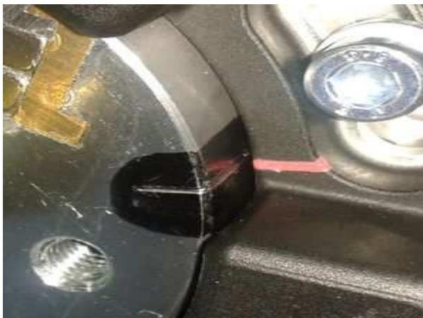
Bringen Sie einen der Kolben (egal welchen, beide zünden gleichzeitig, einer in den Auspuff) in Zündposition. Mit Kurbelwelle in dieser Stellung drehen Sie jetzt den Rotor so auf die Kurbelwelle, daß dessen kleine rote Strichmarkierung etwa an der (hier roten) Strichmarkierung des Stators steht und verschrauben ihn dort. Dabei darf sich die Stellung der Kurbelwelle nicht verändern.
