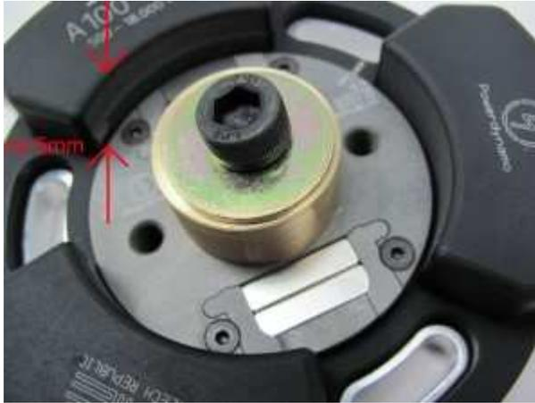
Setzen Sie den Rotor auf die Welle, befestigen ihn aber zunächst noch nicht, er muss eingestellt werden. Es ist richtig das die Oberkante des Rotors ca 5mm unter der Oberkante des Stators liegt.
