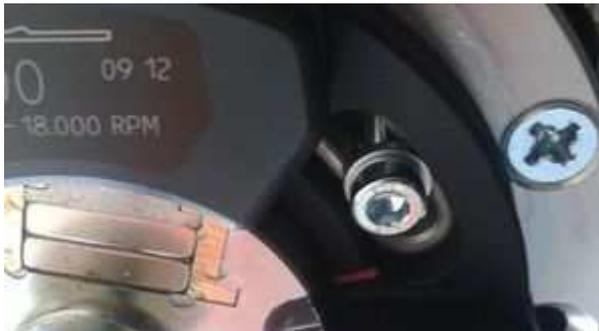
Nutzen Sie die Mitte der Langlöcher zum Verschrauben des Stators um später Spielraum zur Verstellung zu haben.
