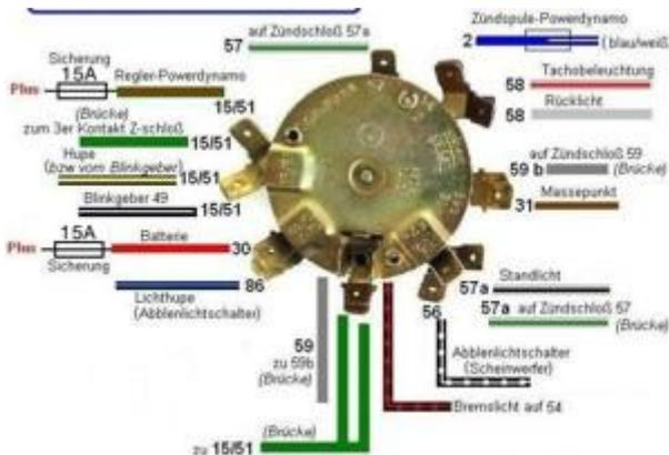
Ein Belegungsschema der Verkabelung am Zündschloß für das neue System.
