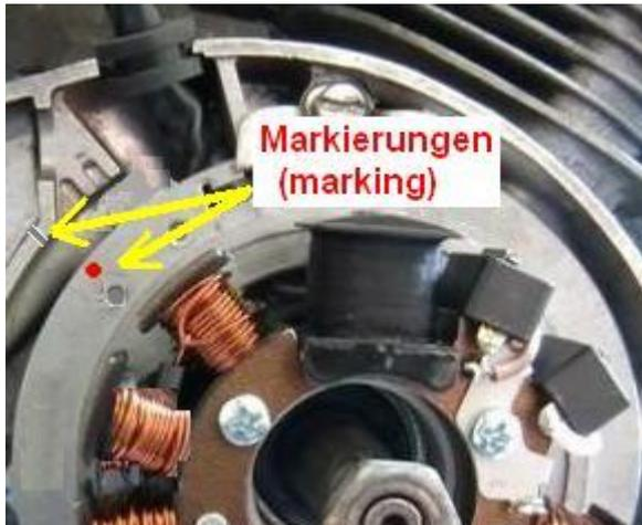
Sehen Sie sich die neue Statoreinheit an. Auf der Grundplatte finden Sie auf Höhe 10-11 Uhr, links von der dicken schwarzen Spule eine rote Zündmarkierungen diese soll mit der Markierung des Zündzeitpunktes auf den Motorgehäuse übereinstimmen. Schrauben Sie die Halteklammern jetzt fest.
