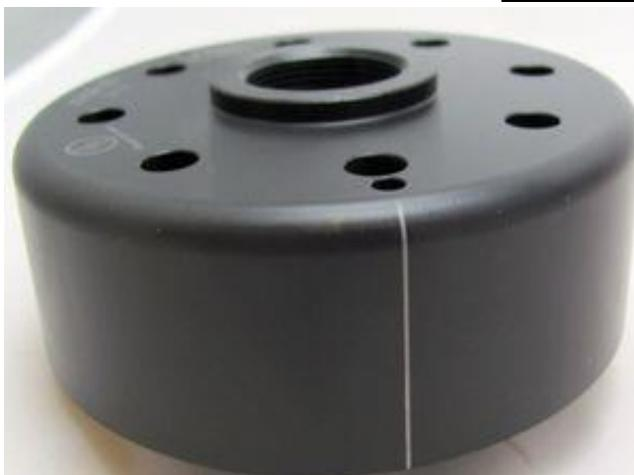
Schauen Sie sich ihren neuen Rotor an, auf seinem Außenumfang befindet sich eine kleine eingepresste Linie. (Hier auf dem Bild zur besseren Erkennbarkeit weiß hervorgehoben.) Das ist eine Zünderstellungsmarke. Diese ist durch die Einpressung dauerhaft, aber eingebaut nicht immer gut zu sehen. Ein Nachziehen mit Faserstift ist daher eine gute Idee.
