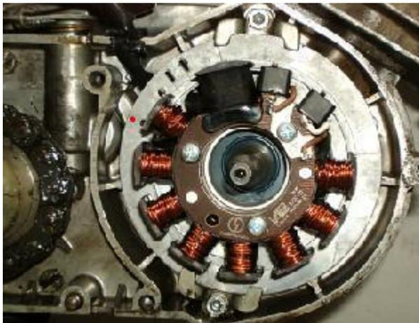
Befestigen Sie die neue Statorplatte anstelle der früheren Lichtzündanlage auf dem Kurbelgehäuse - wie die alte Anlage - mit den Halteklammern.
