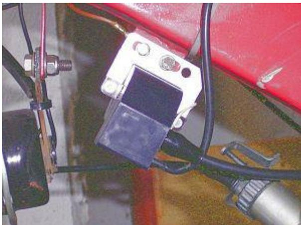
Befestigen Sie die neue Zündspule dort, wo auch die originale Spule befestigt war. Drehen Sie das Zündkabel vorher in die Zündspule. Lassen Sie zunächst eine der beiden Schrauben locker. Hier kommt ein Massekabel hin.
