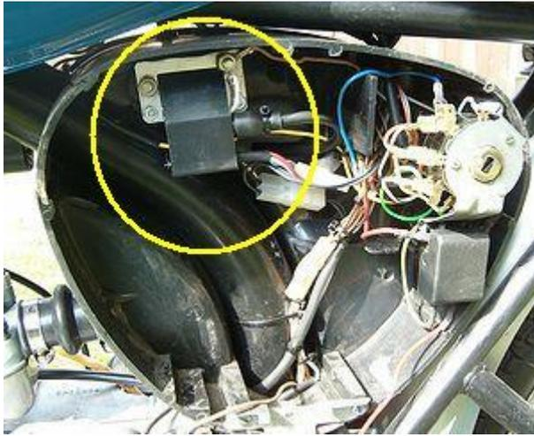
Hier ist die neue Zündspule verbaut im Simson S50 unter dem linken Seitendeckel (Batteriefach). Die alte "Masseschraube" oben im Kasten wurde durch eine neue Schraube M6x50 ersetzen.
