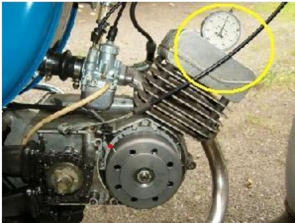
Entfernen Sie die Zündkerze und schrauben Sie ein Zündzeitpunktmessgerät (Messuhr) in das Kerzengewinde des Zylinderdeckels. Bringen Sie den Kolben in die Position "Zündzeitpunkt" (je nach Betriebsanleitung des Fahrzeugtyps, z.B. 1,4 bzw. 1,8 mm vor OT). Da das ganze per Kickstarter kompliziert ist, nutzen Sie den neuen Rotor zum Drehen der Kurbelwelle.
