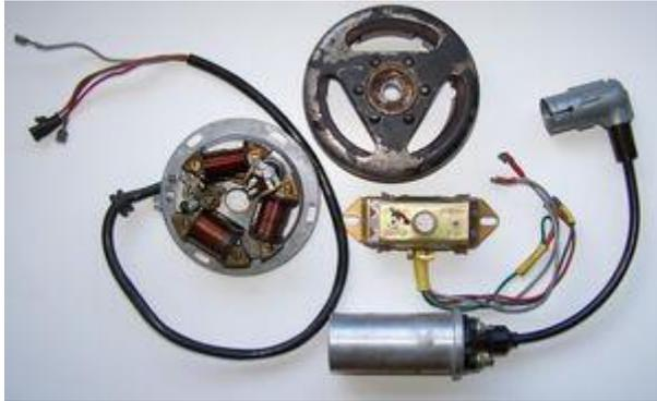
Entfernen Sie alle Teile der alten Licht-Zündanlage
