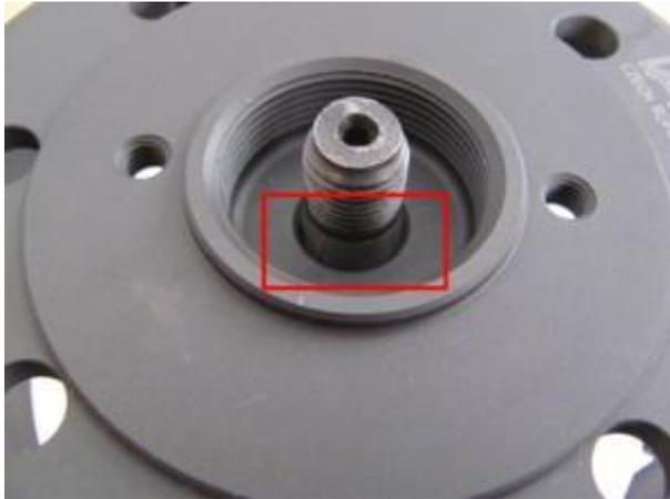
Legen Sie die Unterlegscheibe(n) auf und verschrauben Sie den Rotor mit der originalen Haltermutter. Zum erneuten Lösen des Rotors verwenden Sie den selben Abzieher M27x1,25 wie bei Ihrer Originallima.
