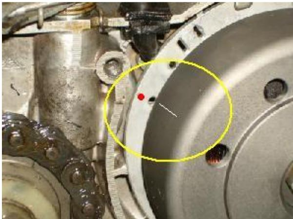
Nehmen Sie den Rotor wieder ab und setzen ihn wieder so auf die Kurbelwelle, dass die Zündmarkierungen auf Statoreinheit und Rotor übereinander stehen.
