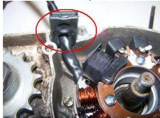
**- Zündungseinstellung:** Zur größtmöglichen Flexibilität der Zündeneinstellung wurde auf eine Anpassung des Rotors auf der Kurbelwelle per Paßfeder und Nut verzichtet. Es besteht dennoch (wenn der Konus korrekt ist) keine Gefahr eines unbeabsichtigten Lösens oder Verdrehens des Rotors, der ohnehin stets durch den Konus, nie die Paßfeder gehalten wurde. Dieser hatte nur eine Führungsfunktion zum Aufsetzen des richtigen Zündzeitpunktes.
