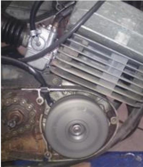
**Vorteile gegenüber dem alten System:****Lichtmaschine/elektronische Zündung für Sachs Supra 4GP**
