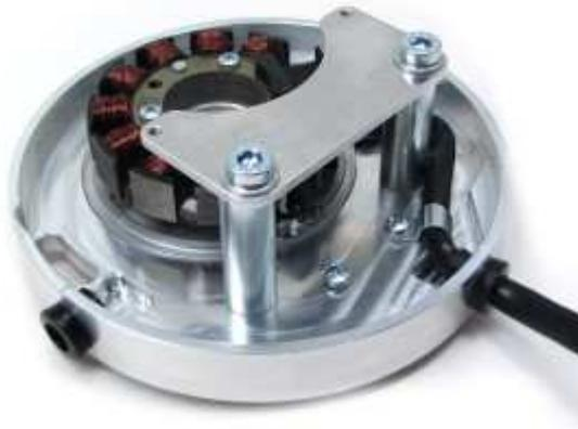
Setzen Sie die zu Beginn der Arbeiten entfernte Halteplatte für den Deckel wieder auf. Diese sitzt auf 2 Distanzröhrchen und wird mit 2 Schrauben M8x60 auf der Grundplatte gehalten.
