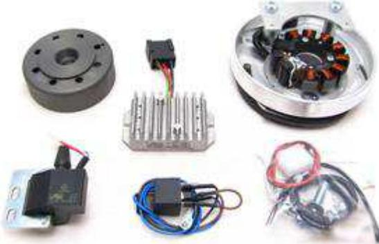
Lichtmagnetzündanlage mit integrierter vollelektronischer Zündung. Lichtleistung 12V/100W Gleichstrom.
