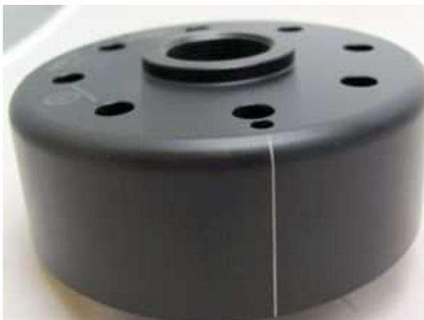
Sehen Sie sich den neuen Rotor an. Sie werden auf seinem Außenumfang eine kleine eingepresste strichförmige Zündmarkierung finden.
