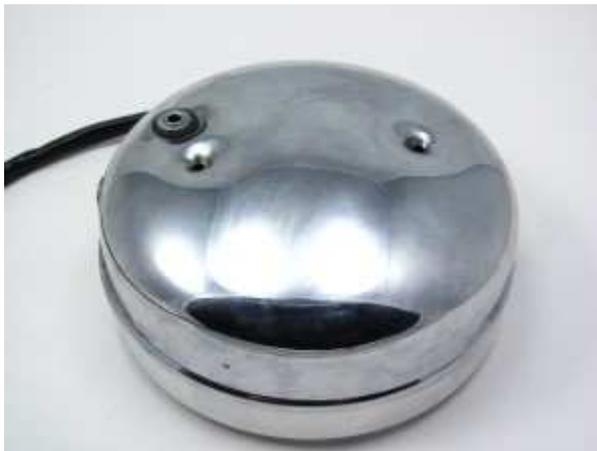
Zum Schluss setzen Sie die Original Abdeckung auf die Statoreinheit und verschrauben diese
