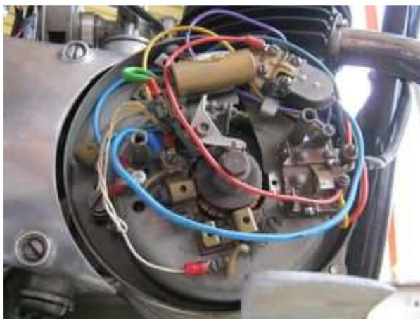
Lösen Sie nun alle Kabel an Ihrer alten Lima und entfernen Sie diese. Nehmen Sie die Passfeder auf dem Konus der Kurbelwelle mit einer Zange ab. Sie wird nicht mehr benötigt! Bitte nicht vergessen sonst müssen Sie die Lima später noch einmal herausnehmen. Keine Angst, die [entfernte Passfeder hatte nicht die Aufgabe](#) den Rotor zu sichern, sondern nur zu verhindern, dass er falsch angesteckt wird.
