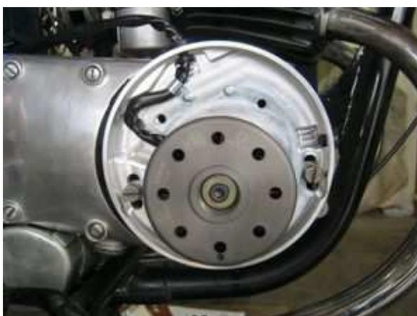
Ziehen Sie nun den Rotor leicht von der Kurbelwelle und stecken ihn dann wieder so auf die Kurbelwelle, dass die Strichmarkierung des Rotors mit der Punktmarkierung der Grundplatte übereinstimmt. Achten Sie während dieser Prozedur darauf, dass sich die Kurbelwelle nicht verdreht (die Magneten ziehen gerne seitlich). Verdreht sich was, bitte noch einmal beginnen. In dieser Position schrauben Sie den Rotor mittels der Schraube M8x50 (Vergessen sie bitte nicht die Unterlegscheibe!) sicher fest.
