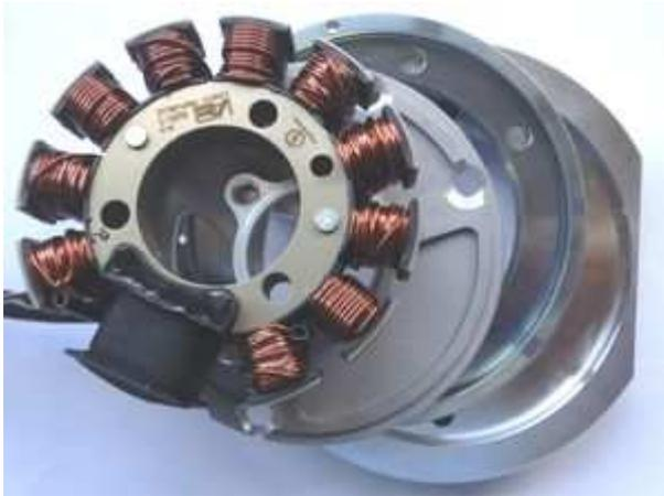
Lösen Sie die 3 Innensechskantschrauben M6 und ziehen Sie den Stator etwas von seiner Grundplatte (um Zugang zu den Schrauben zu erhalten).
