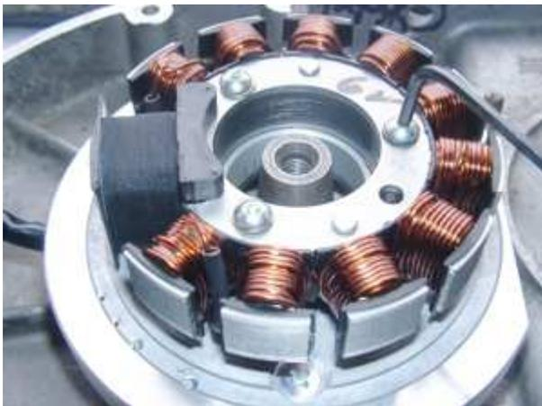
Setzen Sie den Spulenkörper wieder auf die Platte. Achten Sie darauf, keine Kabel darunter einzuklemmen, achten Sie zudem darauf, dass der Arretierbund der Alu-Platte exakt im Innenring des Spulenkörpers zu sitzen kommt. Wenn der Spulenkörper verkantet sitzt, besteht die akute Gefahr einer Zerstörung durch Rotorkontakt.
