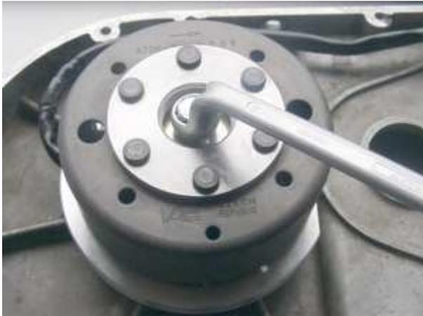
Setzen Sie den Rotor auf die Kurbelwelle und befestigen Sie ihn mit dem beiliegenden Rotorbolzen M7x30. Vergessen Sie nicht die Unterlegscheibe.
