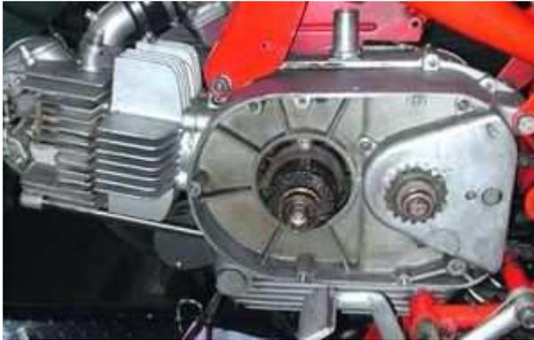
Nehmen Sie den Limadeckel ab. Klemmen Sie alle Kabel an der Lichtmaschine ab und ziehen Sie die Kabel aus dem Motorgehäuse. Schneiden Sie aber zunächst keine ab.
