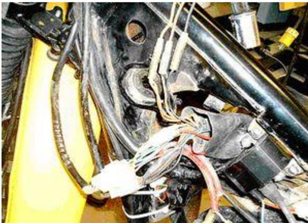
7. Suchen Sie das gelbe Kabel und verbinden das mit dem roten Kable vom neuen Regler. Es liefert den gesamten Strom für das neue System. Es ist im Schaltplan mit einem "D" gekennzeichnet
