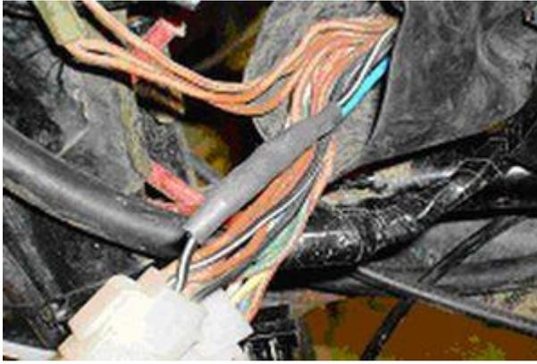
6. Suchen Sie das Schwarz/Weiße Kabel, welches vom Zündschloss kommt und zur Abschaltung ist. Verbinden Sie das mit dem blauen Kabel von der Zündspule. Es ist im Schaltplan mit einem "B" gekennzeichnet
