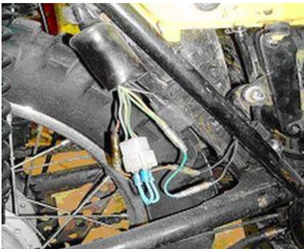
8. Wenn Sie das alte System entfernen, finden Sie ein weisses Plastikgehäuse vom alten Stator. Dies finden Sie links unter dem Öltank. Es ist im Schaltplan mit einem "C" gekennzeichnet. Machen Entfernen Sie das Gehäuse und verbinden Sie alle drei Kabel miteinander. Nun hat das Motorrad komplett Strom
