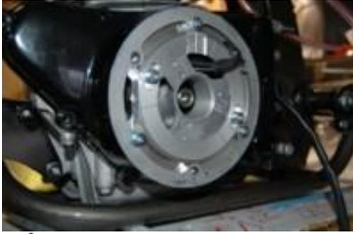
**Elektronische Zündung / Lichtmaschine für Honda CB 175**
