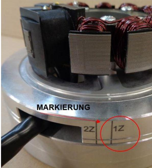
Stecken sie den Rotor nun so auf die Kurbelwelle, dass die Markierung auf dem Umfang genau an der Markierung der Adapterplatte steht und drücken Sie den Rotor fest auf die Welle.
