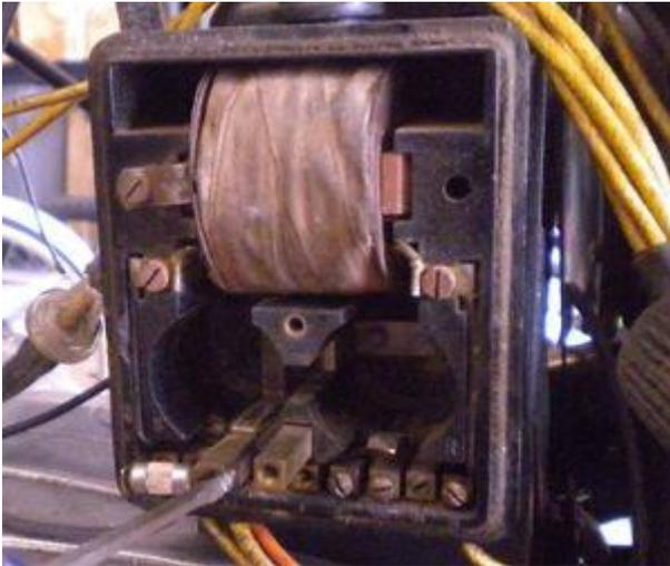
Eine elegante, aber recht aufwendige und fummelige Lösung ist die Unterbringung der neuen Zündspule im Spulenkasten. Aufwendig deshalb, weil sowohl das Innenleben des Spulenkastens, als auch die neue Zündspule modifiziert werden müssen.
