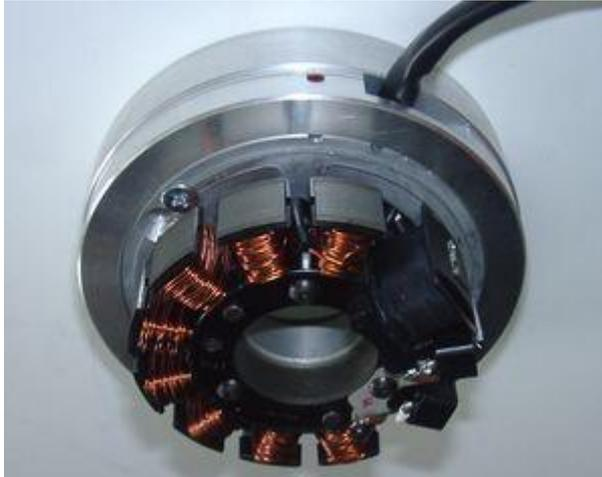
Setzen Sie die komplette neue Spuleneinheit (Stator) so auf den DKW Teller, daß das Kabel in Richtung Kabelbohrung zeigt und verschrauben Sie die Einheit dort (von hinten) mit 3 Senkkopfschrauben M5x30.
