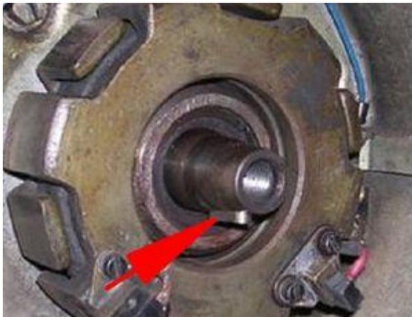
Entfernen Sie die Paßfeder von der Kurbelwelle. Sie wird nicht mehr benötigt und stört jetzt.
