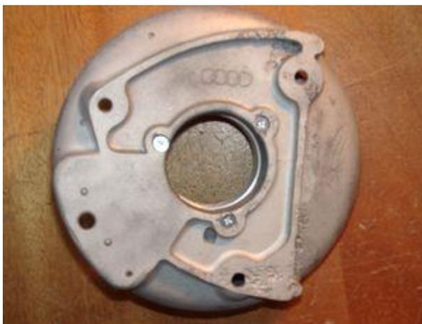
Die neue Statoreinheit wird so an dem DKW "Teller" verschraubt, wie auch der alte Stator.
