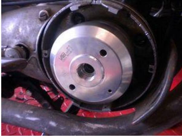
Stecken sie nun den Rotor auf die Kurbelwelle. Prüfen Sie bitte, ob der Rotor nach unten zur Grundplatte frei läuft und nicht auf dieser schleift.
