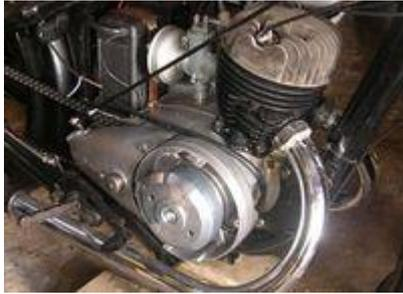
Der Zündzeitpunkt ist statisch, die modernen Kraftstoffe machen eine Verstellung überflüssig. Das Gewicht des neuen Rotors (Durchmesser 137mm) beträgt 3kg, anstelle der original 5kg. Das entlastet die Lager und gestattet einen sehr guten Rundlauf. Am Motorblock werden keine Veränderungen notwendig (außer einer Vergrößerung des Kabelausgangsloches um 2mm). Das System ist in der Lage ohne Batterie (beachten Sie einige Einschränkungen) auszukommen.
