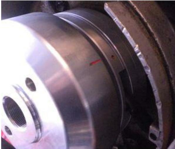
Sehen Sie sich den neuen Rotor an. Sie werden auf seinem Außenumfang eine kleine Strich- (ältere Anlagen: Punkt-) Markierung finden. Sehen Sie sich auch die obere Adapterplatte an, hier finden Sie ebenfalls eine punktförmige rote Markierung.
