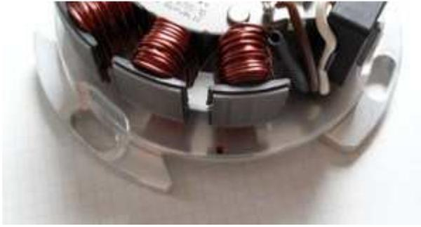
Sehen Sie sich die neue Grundplatte mit dem vormontierten Stator an. Auf ihr finden Sie eine rote Markierung. Das ist eine Zündmarkierung. Diese wird später durch den Rotor verdeckt, daher sollten Sie sie auf dem Motorgehäuse verlängern.
