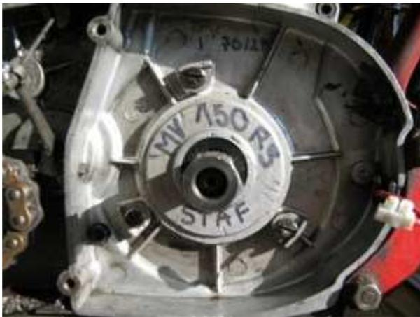
Entfernen Sie den alten Rotor mit einem geeigneten Abzieher. Lösen Sie die drei Schrauben der Statorplatte.
