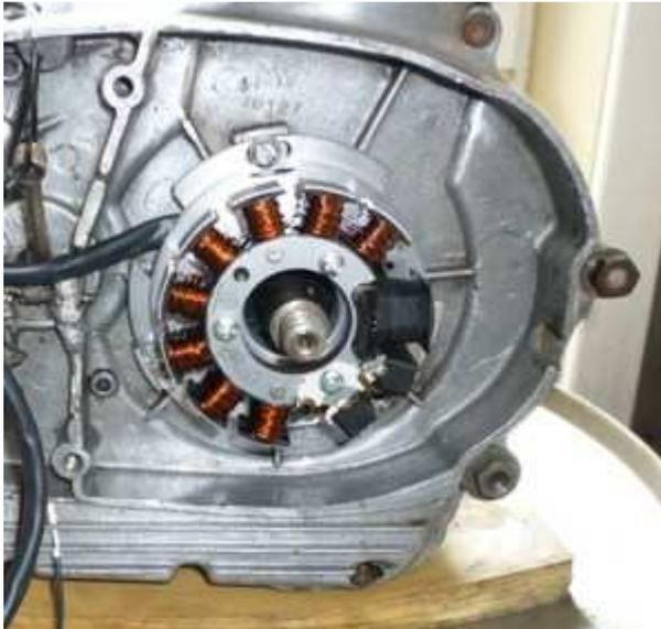
Setzen Sie die vormontierte Statoreinheit auf den Sitz der Lichtmaschine der MV. Verschrauben Sie diese dort mit den mitgelieferten 3 Linsenkopfschrauben M5 und Unterlegscheiben.
