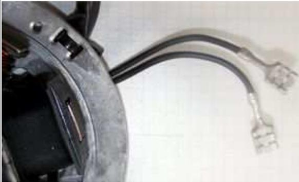
Die beiden schwarzen aus der Lichtmaschine kommenden Kabel führen die Spannung für Licht, Hupe, Blinker usw. Sie haben nichts mit der Zündung zu tun.
