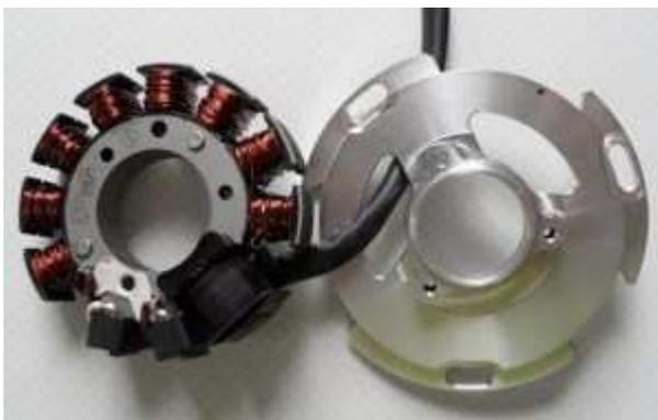
Falls Sie einmal den Stator doch einmal ganz von der Grundplatte abnehmen sollten, merken Sie sich unbedingt seine Lage. Eine Veränderung (wenn der Stator kabelbaum durch die falsche Öffnung der Grundplatte geführt wird) bringt zwangsläufig eine um 120° veränderte ZündEinstellung und damit ein Hinfälligwerden der Markierung mit sich.
