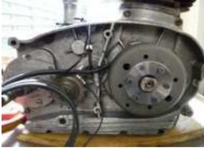
Lichtmaschine/elektronische Zündung für [MV Agusta 150RS](#)
