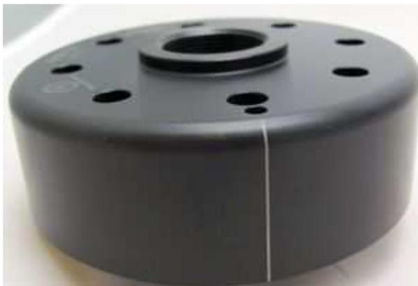
Sehen Sie sich jetzt den Rotor an, auf seinem Außenumfang finden Sie eine eingepresste Marke. Auch das ist eine Zündmarkierung. Die Markierung ist dauerhaft, aber schlecht sichtbar. Es ist daher eine gute Idee sie mit einem Faserstift zu verstärken.
