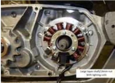
Lichtmagnetzündanlage mit integrierter vollelektronischer Zündung. Lichtleistung 12V/70W Wechselstrom. Kontaktlose elektronische Zündung. Ersetzt die komplette alte Magnet-Licht-Zündanlage, Unterbrecher, Zündspule. Sie benötigen an Ihrem Motorgehäuse keine Veränderungen.
