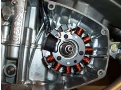
Lichtmagnetzündanlage mit integrierter vollelektronischer Zündung. Lichtleistung 12V/70W Wechselstrom. Kontaktlose elektronische Zündung mit eigener Stromversorgung innerhalb der Anlage. Ersetzt die [alte Motoplat Anlage](#) einschließlich Zündspule. Sie benötigen an Ihrem Motorgehäuse keine Veränderungen. Ein weiteres betreiben der ULO Box ist jedoch nicht mehr möglich, da das System mit 12Volt arbeitet. Das System ist technisch in der Lage komplett [ohne Batterie](#) betrieben zu werden.
