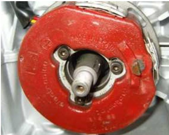
Lösen Sie die Befestigungsmutter des Rotors ([mit geeignetem Werkzeug](#)) und ziehen Sie ihn mit Hilfe des [geeigneten Abziehers](#) ab.
