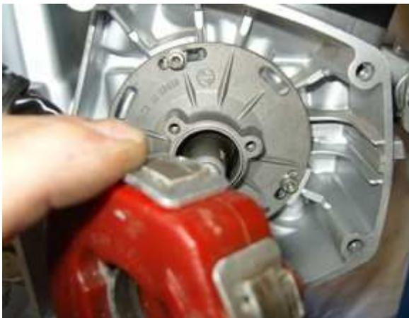
Lösen Sie die 3 Statorbefestigungsschrauben und nehmen Sie die Motoplat-Einheit ab. Danach die 3 Schrauben der Grundplatte lösen und die Grundplatte herausnehmen.
