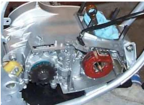
Lösen Sie alle elektrischen Verbindungen zur alten Motoplatt, der Zündspule und zur ULO-Box. Entfernen Sie die alte Zündspule.
