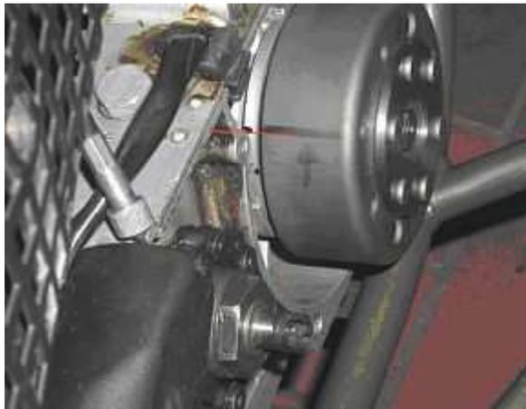
Entfernen Sie die Zündkerze und bringen Sie den Kolben in Zündposition. Bitte konsultieren Sie dazu ihr Handbuch (125cm<sup>3</sup>: 0,7-1,2mm vor OT / 175-255cm<sup>3</sup>: 1,7-2,2mm). Stecken Sie dazu den neuen Rotor relativ lose auf. Sie können damit die Kurbelwelle drehen.
