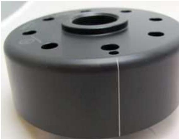
Sehen Sie sich den neuen Rotor an. Auf seinem Umfang finden Sie eine kleine eingepresste Strichmarkierung. Das ist eine Zündeneinstellmarke. Diese ist durch die Einpressung dauerhaft aber eingebaut nicht immer gut zu sehen. Ein Nachziehen mit Faserstift ist daher eine gute Idee.
