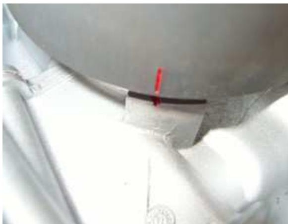
Halten Sie die Stelle des Zündzeitpunktes, nehmen Sie den neuen Rotor vorsichtig wieder ab und stecken Sie ihn wieder so auf, daß die Markierung auf der Außenseite des Rotors auf Höhe der Markierung auf der linken Seite der Statorplatte zu stehen kommt.
