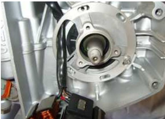
Entfernen Sie die 3 Schrauben, die den neuen Stator auf seiner Grundplatte halten und ziehen Sie ihn etwas von der Platte weg, so daß Sie Zugang zu den Befestigungslöchern darunter erhalten. Achten Sie darauf, die Lackisolierung der Spulendrähte nicht zu beschädigen.
