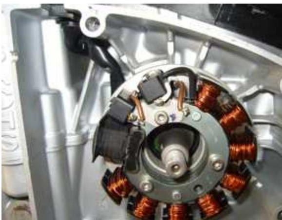
Setzen Sie den Stator wieder auf die nun am Motor verschraubte Grundplatte. Die dicke schwarze Spule zeigt dabei etwa in Richtung 10 Uhr. Die Spule muss dort recht hart einrasten. Setzt Sie nur weich auf die Platte auf, ist mit großer Sicherheit ein Kabel darunter eingeklemmt! Stellen Sie sicher, daß der Stator gerade auf der Platte sitzt und keine Kabel eingeklemmt sind - ansonsten kommt es zur Zerstörung der Anlage oder zumindest Fehlfunktionen.
