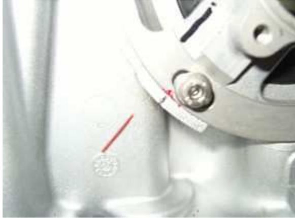
Da diese Markierung nach Montage des Rotors nicht sichtbar ist, bietet es sich an diese Markierung in das Motorgehäuse zu übertragen.
