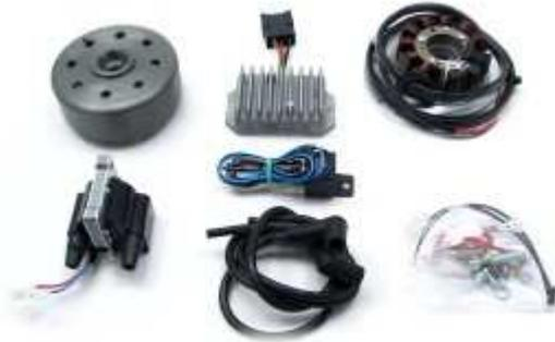
Lichtmagnetzündanlage mit integrierter Zündung und
