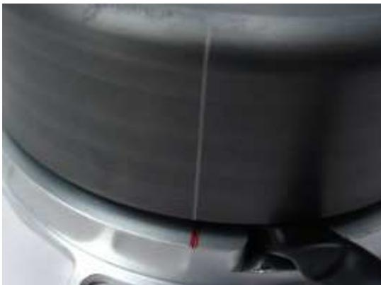
Sehen Sie sich den neuen Rotor an. Sie werden auf seinem Außenumfang eine gelaserte Linie finden, das ist auch eine Zündmarkierung.
