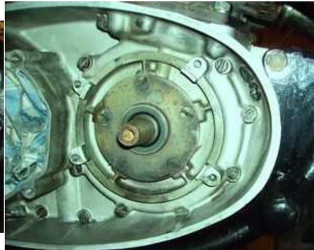
Setzen Sie die neue Statoreinheit auf den Motor und verschrauben Sie diese. Das Kabel muss dabei Richtung Kabelausgang zeigen und die dicke schwarze Spule etwa auf 9 Uhr liegen.
