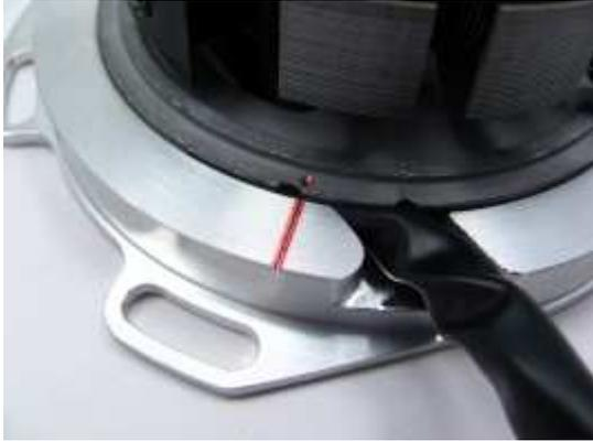
Bitte beachten Sie die kleine (rote) Markierung der Stator-Grundplatte zwischen den eingesenkten Befestigungslöchern.
