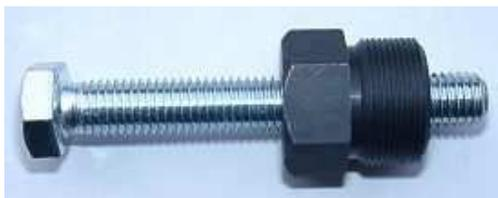
**ACHTUNG:** Bei Verwendung eines Klauenabziehers lösen sich die Magnetee im Rotor!
