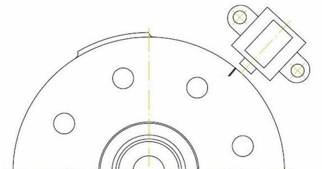
... setzen Sie den Rotor wieder zurück auf die Kurbelwelle. Und zwar so, daß die linke Kante des Sensorkerns an der Rotormarkierung steht, wie hier gezeigt.
