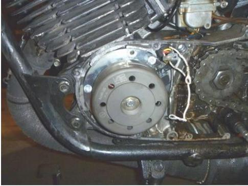
**System Lichtmaschine & Zündung mit Zündverstellung für frühe luftgekühlte Yamaha RD mit original Unterbrechersteuerung,**
