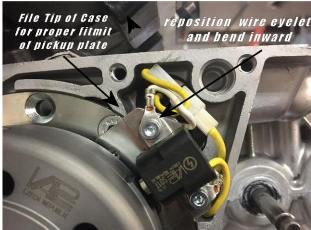
der beiden weißen Kabel nach unten zu biegen (siehe Bild, durch Anklicken vergrößerbar). Mitunter (wirklich in seltenen Fällen, es scheint recht verschiedene Deckel zu geben) müssen Sie etwas Material von der Innenseite des Deckels abnehmen.
