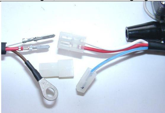
... nehmen Sie den weiblichen Stecker der Zündspule mit den Kabelfarben rot und weiß. Stecken Sie die lose mitgelieferte 2er-Steckerhülse auf diesen Stecker und führen Sie die losen Kabel der Lichtmaschine (rot und weiß) mit den Kontaktfahnen hinten in den Stecker ein. Achten Sie darauf, daß die Steckerfahnen in dem Steckergehäuse einrasten. Dabei ist strikt auf die korrekte Position dieser Kabel im Stecker zu achten:
